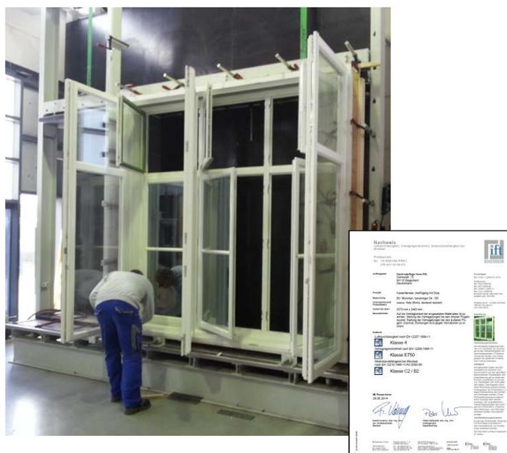
**Bild 4** Prüfung der Luft- und Schlagregendichtheit von Sonderkonstruktionen mit Prüfbericht des ift Rosenheim (Bildquelle und Freigabe Prüfbericht durch Denkmalpflege Ritt)
