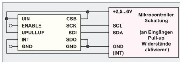
Bild 7: Anbindung des 3D-BS-Moduls an eine Mikrocontroller-schaltung über I<sup>2</sup>C
