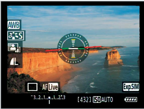
Bild 2: Kamera mit Beschleunigungssensor: optische Unterstützung zur einfachen Ausrichtung des Bildhorizonts (Foto: Canon)
