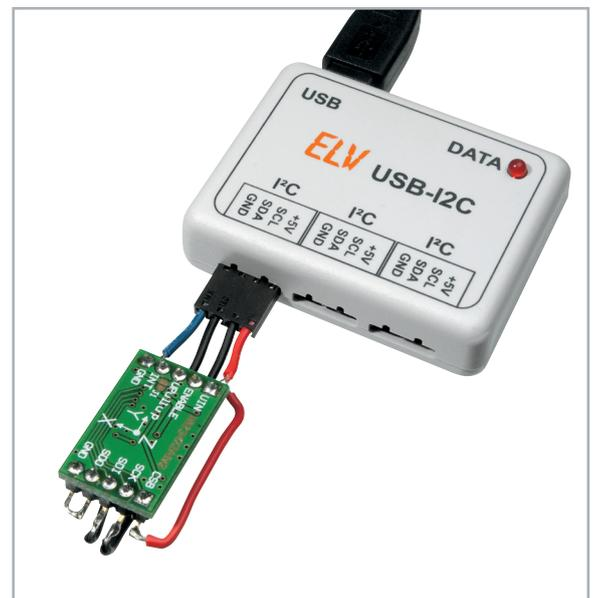
Bild 10: „Fliegende Verbindung“ des 3D-BS mit dem USB-I<sup>2</sup>C-Interface
