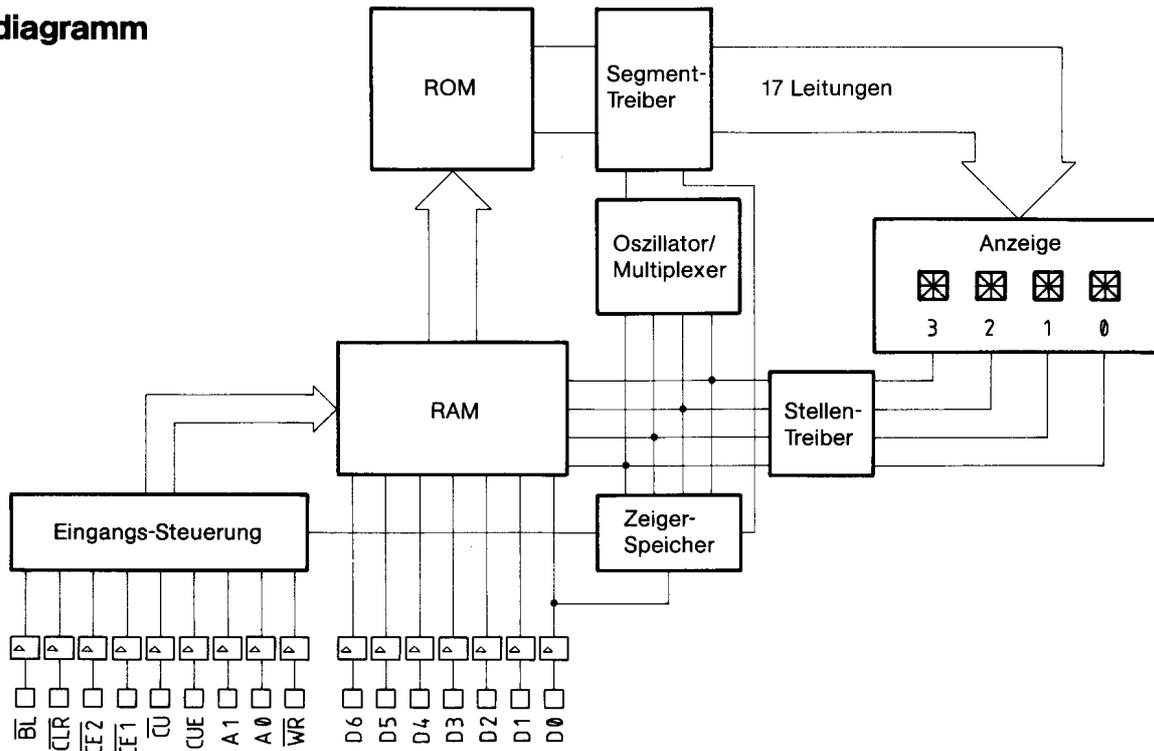
Die buskompatiblen LED-Anzeigen bieten die Möglichkeit, übersichtliche Frontplatten zu bauen. Die Module kann man unmittelbar nebeneinander anordnen; dadurch werden beliebig lange alphanumerische Anzeigensysteme ermöglicht.
