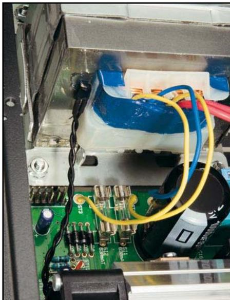
Bild 20: Der Temperatursensor wird direkt an den Trafokern gelötet.
