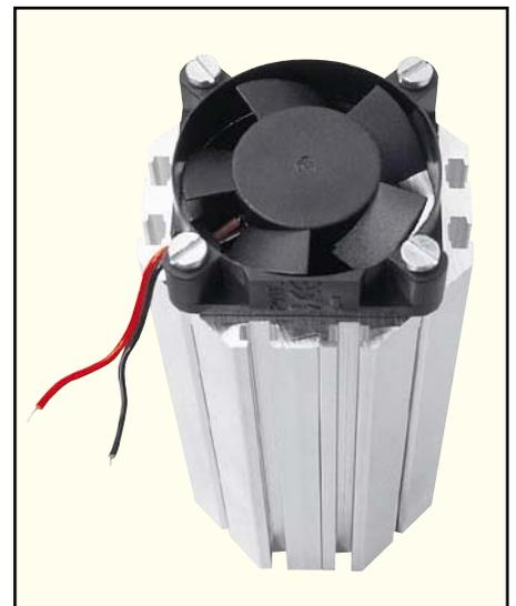
Bild 7: Montage des Lüfters am Kühlkörper
