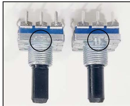
Bild 14: Die Führungsnase des Inkrementalgebers (rechts) wird abgeschnitten (links).
