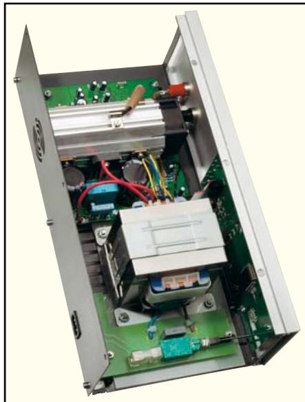
Bild 22: Innenansicht des fertig gestellten PPS 5330
