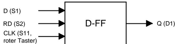
Abb. 7.17 D-Flipflop mit asynchronem Reset
