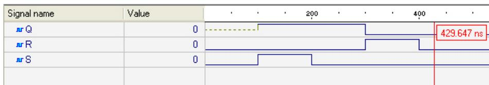
Abb. 7.4 Simulation des RS-Flipflops
