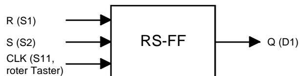
Abb. 7.7 RS-Flipflop mit Taktsteuerung
