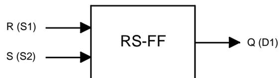
Abb. 7.1 RS-Flipflop ohne Taktsteuerung
