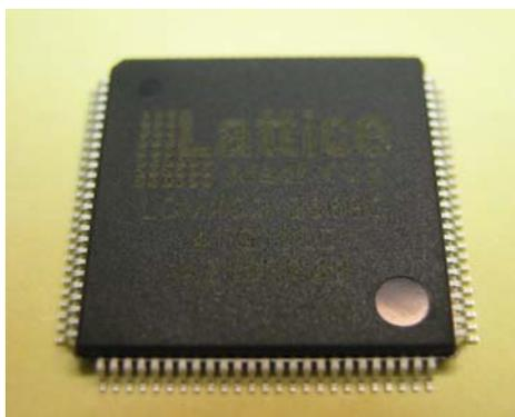
Abb. 2.1 MACH XO2-256 im TQFP100-Gehäuse
