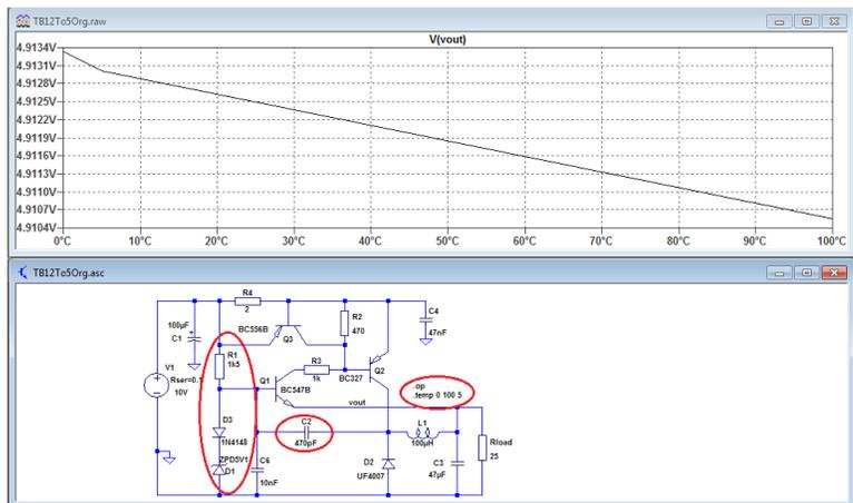
Der Kondensator C2 musste von 2,2nF auf 470pF verringert werden, um ein einwandfreies funktionieren der Schaltung zu gewährleisten. Dadurch erhöht sich die Arbeitsfrequenz auf 190,5kHz.
