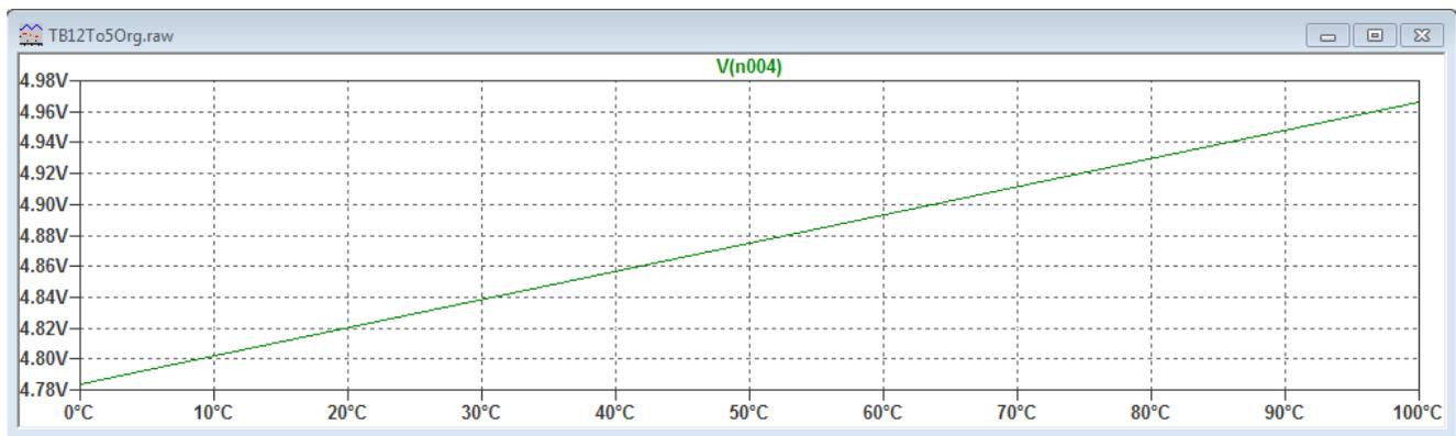
Hier ist zu erkennen, dass die Ausgangsspannung bei 0°C 4,78V und bei 100°C 4,98V beträgt. Damit ändert sich die Spannung im untersuchten Bereich um 180mV. Das ist nicht viel, zumal der Arbeitstemperaturbereich deutlich kleiner ist.
