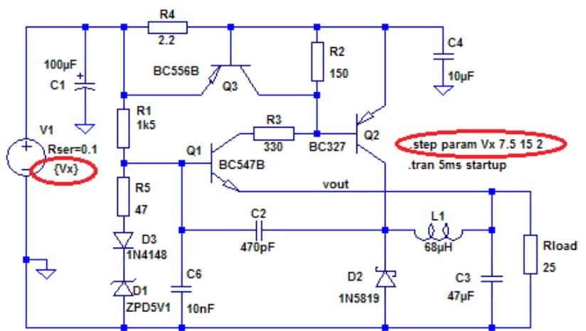
Bei 9V Ein: Ausgangsspannung 4,91V, Strom 169mA, Frequenz ~ 168kHz, Wirkungsgrad ~ 75%
