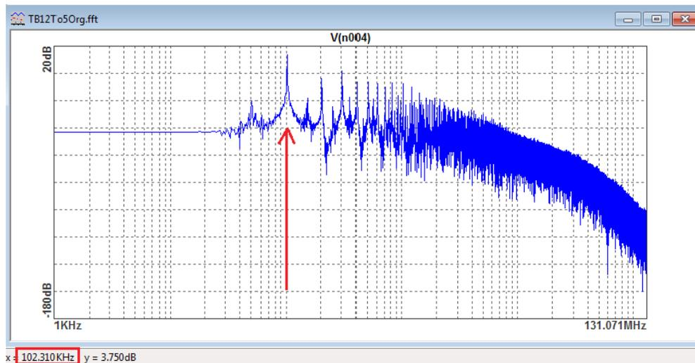
Im FFT-Diagramm den Cursor auf den Peak der Grundwelle (erster deutlicher Peak) und unten links die Frequenz ablesen. Hier sind es 102,31kHz, da lag die überschlägige Rechnung nicht so falsch.
