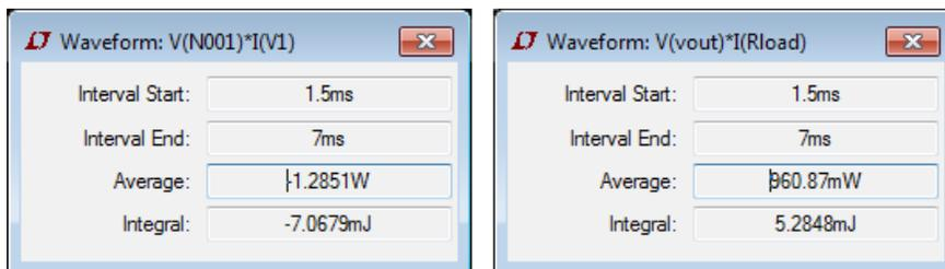
Die neue Ausgangsleistung ist 960,97mW, die neue Eingangsleistung ist 1285,1mW daraus ergibt sich ein Wirkungsgrad von  $(960,97 / 1285,1) \times 100 = 74,76\%$ .
