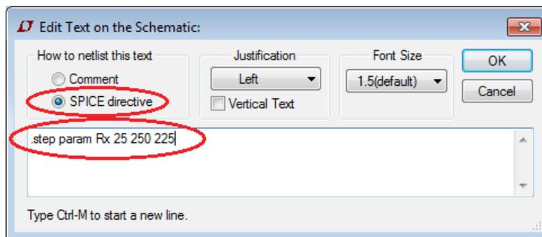
schreiben. Das bedeutet, der Widerstandswert „Rx“ von Rload beginnt mit 25 Ohm und endet bei 250 Ohm, die Schrittweite ist 225 Ohm. Damit werden zwei Werte erzeugt, 25 Ohm und 250 Ohm, für die Lastströme 200mA und 20mA. Bei einer kleineren Schrittweite sind auch mehr als zwei Lastströme möglich, mich interessiert im Moment aber nur die Änderung der Ausgangsspannung bei einem kleinen und dem maximalen Strom.
