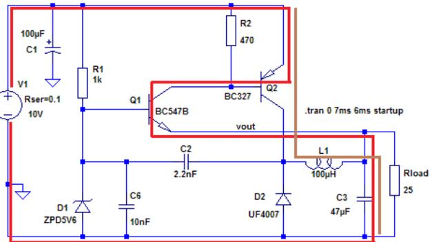
2 Die Überhöhung der Ausgangsspannung beim Einschalten auf über 7V.
