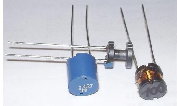
Somit ist die Induktivität der Spule bekannt und sie ist mit diesem Wert in der Simulation einsetzbar. Ich verwende den gerundeten Wert von 100µH. Der Drahtwiderstand ist nicht groß, ich wähle 0,1 Ohm.
