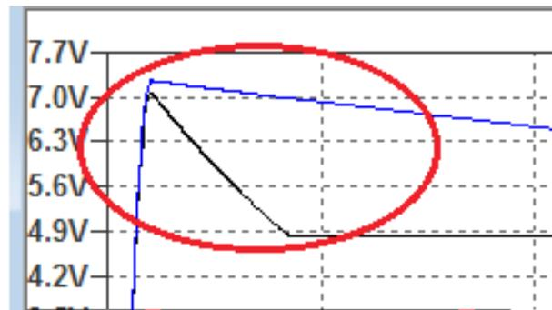
3 Die starken Stromspitzen und die damit verbundenen Leistungsspitzen während der steigenden Schaltflanke von Transistor Q2.
