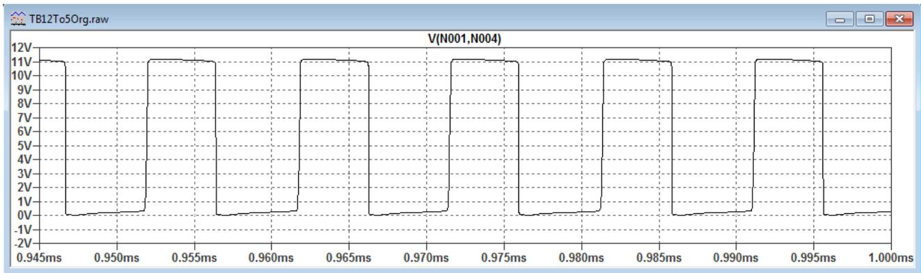
Die Kollektor/Emitterspannung bewegt sich zwischen 0V und 11Volt und liegt damit im erlaubten Bereich für den BC327 mit maximal 45Volt.
