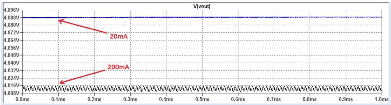
Die Ausgangsspannung bei 200mA Last beträgt 4,812V und bei 20mA 4,888V das macht 76mV Änderung. Das ist für so eine einfache Schaltung nicht schlecht.
