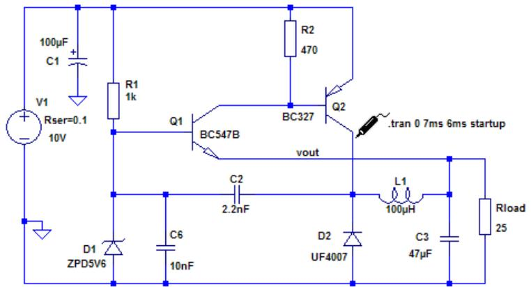
Zum ermitteln der Schaltfrequenz eine Spannungsprobe am Kollektor von Transistor Q2 nehmen.
