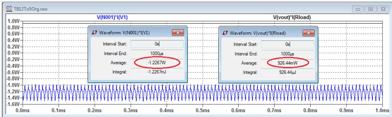
Durch anklicken des Tracetitel bei gedrückter Ctrl-Taste lassen sich die Effektivwerte anzeigen. Für die Eingangsleistung wird 1,2267 Watt gezeigt, für die Ausgangsleistung 926,44mW. Daraus kann der Wirkungsgrad mit der Formel:
