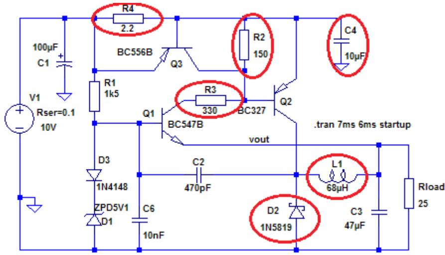
Der Widerstand R4 ist auf den Normwert 2,2 Ohm vergrößert, das vermindert den Kurzschlussstrom für Q2 auf ca. 350mA.
