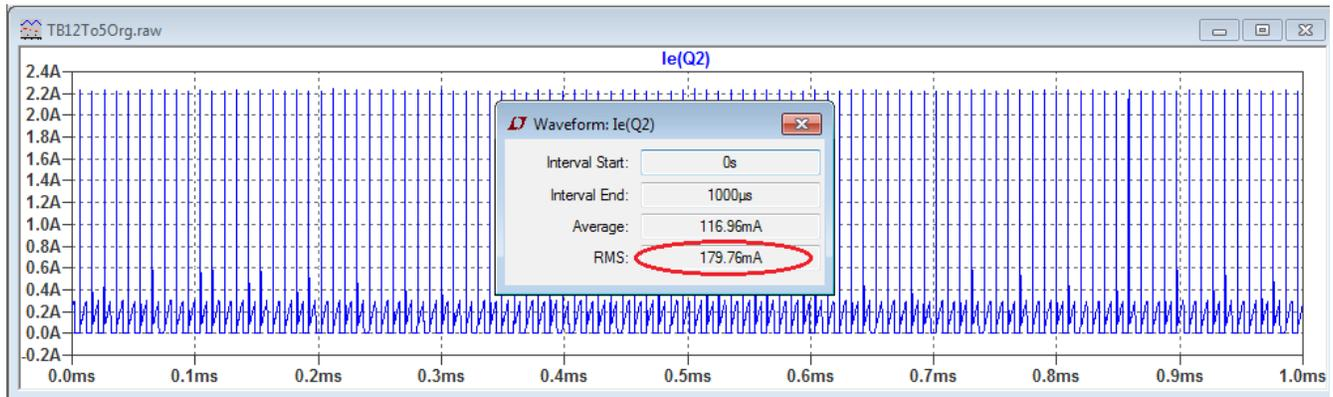
Es ist zu sehen, dass Stromspitzen bis zu 2,2 Ampere auftreten. Ein Klick, bei gedrückter Ctrl-Taste, auf den Titel des Trace „Ie(Q2)“ öffnet das Fenster der genauen Anzeige. Hier ist unter „RMS“ der effektive Strom im gewählten Zeitabschnitt ablesbar 179,76mA.
