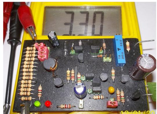
Der Wirkungsgrad eines Linearreglers wäre hier (12V zu 3,3V) 27,5%.
