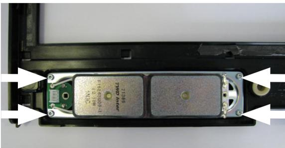
Wenn Sie den Frontrahmen vom Display komplett gelöst haben, entfernen Sie die beiden TV-Lautsprecher, diese sind mit jeweils vier Torxschrauben der Größe T10 im Frontrahmen befestigt, siehe **Abb. 14**.
