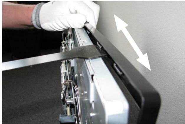
An den Seiten des Displays muss das Werkzeug auf und ab bewegt werden.
