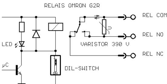
Vom Relais ist jeder Wechselkontakt separat auf die Anschlussleiste geführt. Der Schließer ist mit einem Varistor 390V entstört. Der Öffner ist unbeschaltet.
