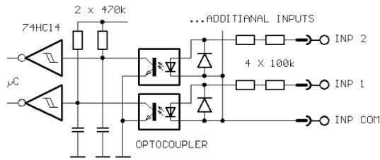
Der Anschluss INP COM wird für alle 4 Eingänge einer Gruppe gemeinsam genutzt. Die Eingänge sind über Optokoppler potentialgetrennt. Die Eingangswiderstände sind für einen Eingangsspannungsbereich von 180..240V AC ausgelegt. Ausgewertet wird nur die positive Halbwelle. Betrieb mit DC ist prinzipiell auch möglich, falls das negative Potential an INP COM anliegt.
