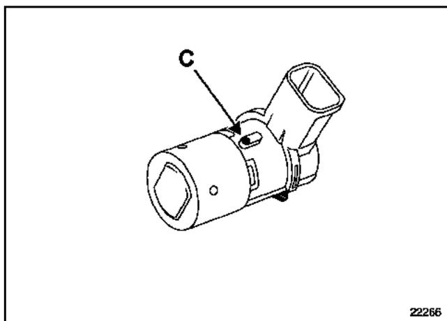
**ACHTUNG:** Die Sensoren sind wärmeempfindlich (Temperatur über 80°C).
