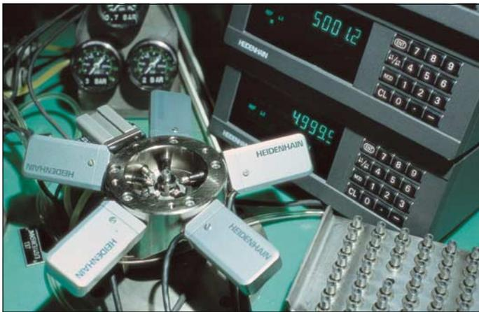
Toleranzmessung an Düsenkörpern
