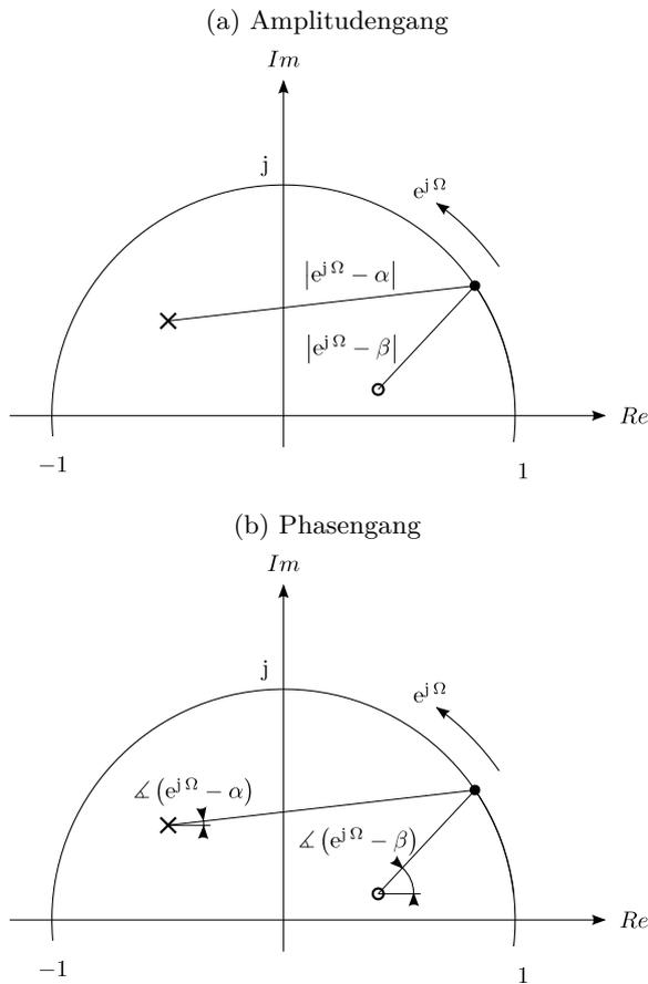
Abb. 23.1. Einfluss der Pole und Nullstellen auf den Amplitudengang
