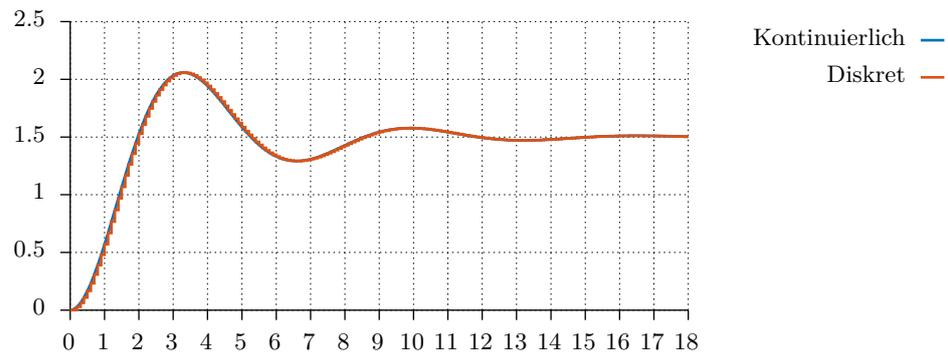
**Abb. 23.4.** Sprungantwort eines kontinuierlichen Systems und der mit Halteglied diskretisierten Variante
