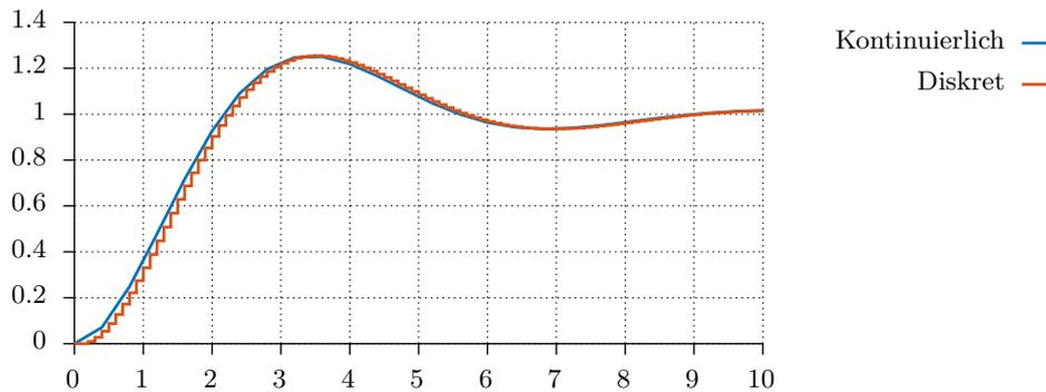
**Abb. 23.2.** Sprungantwort der kontinuierlichen und der diskretisierten Übertragungsfunktion unter Verwendung der Matched  $z$ -Transformation
