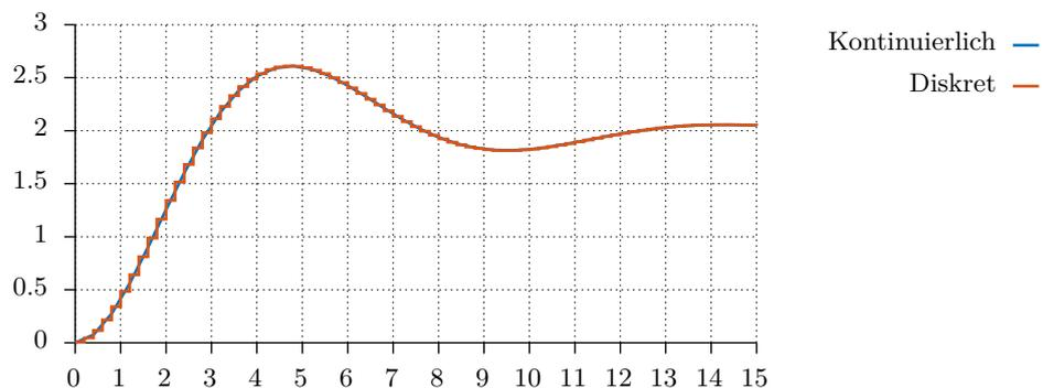
**Abb. 23.3.** Sprungantwort der kontinuierlichen und der diskretisierten Übertragungsfunktion unter Verwendung der bilinearen Transformation
