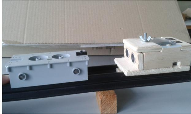
Per Ultraschall wird ca. sechsmal je Sekunde der Abstand des grauen Wagens vom Messgerät bestimmt. Die Spannungsversorgung erfolgt über ein Micro-USB-Netzgerät.
