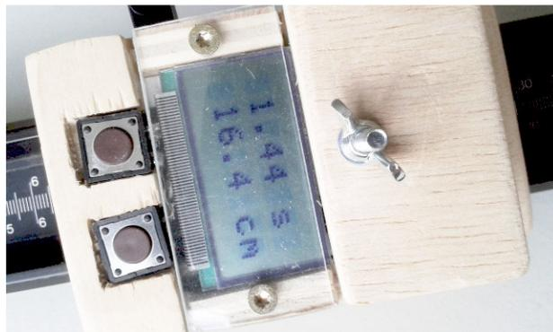
Die Messwerte lassen sich nach der Messung bequem ablesen. Alternativ kann man auch einen Laptop anschließen und eine umfangreichere Messserie herunterladen.
