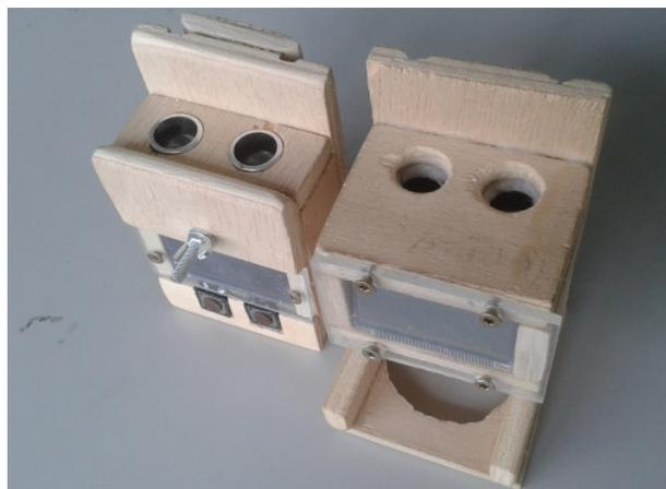
Die Geräte lassen sich auch senkrecht aufstellen, um darüber schwingende Federpendel zu „beobachten“. Rechts die ältere Variante von 2014-2015, die Version 2.0 (links) lässt sich einfacher bedienen und ist kompakter und stabiler.
