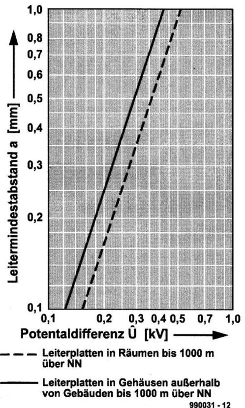
Neben diesen technischen Minimalforderungen sind auch noch Sicherheitsvorschriften einzuhalten, wenn eine Platine mit der Netzspannung verbunden ist. Daraus ergibt sich ein minimaler Leiterbahnabstand von 3mm zwischen Leiterbahnen, die Netzspannung führen, was deutlich mehr ist als der Abstand, der für diese Spannung aus dem Diagramm zu entnehmen ist. Bei einem Gerät mit doppelter Isolation (schutzisoliert, ohne Verbindung mit einem Schutzleiter) ist außerdem ein Mindestabstand von 6 mm
