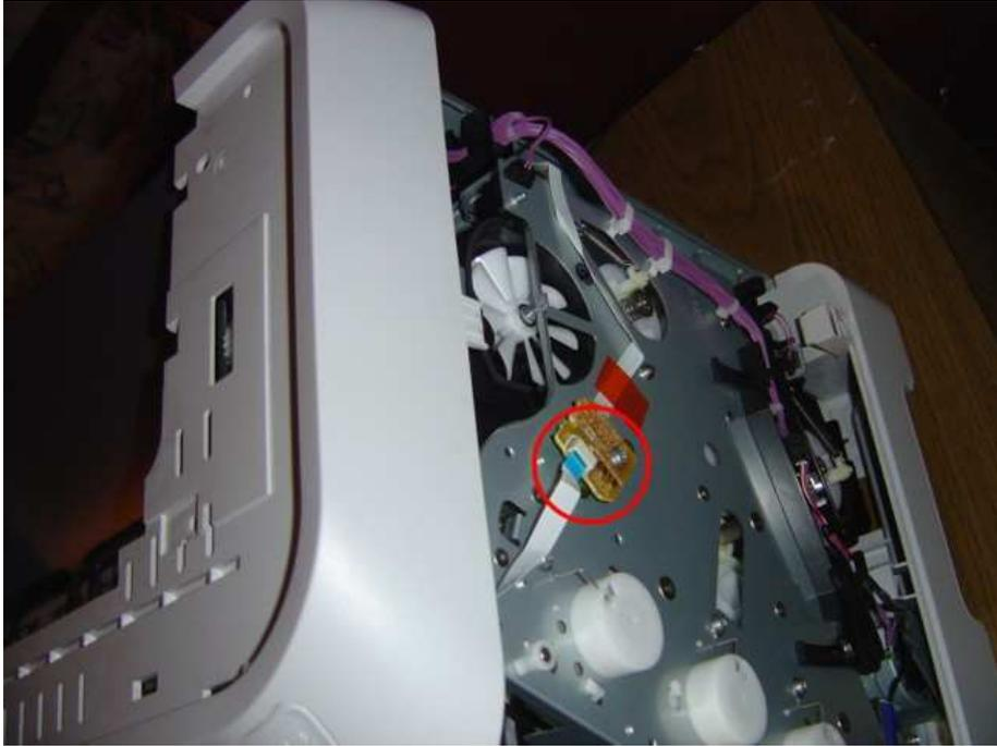
Seitenverkleidung mit sanfter Gewalt abziehen. Hier sieht man die Verbindung für Display und Taster, diese abziehen. Weiß nicht, ob der Stecker zum Betrieb angeschlossen sein muß, ich hatte in später immer verbunden.
