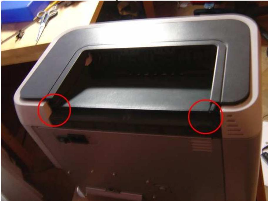
Bei den roten Markierungen die Stifte mit einem Schraubenzieher eindrücken und die Abdeckung nach oben wegziehen. Bei mir hat es nur von oben funktioniert, also dort wo die Stifte auch eingesteckt werden, sie rauszuhebeln. Macht ein unangenehmes Geräusch, bei mir ist aber nichts abgebrochen.
