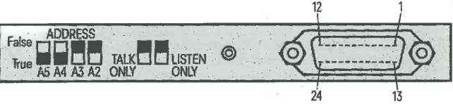
Bild 13 Bedien- und Anschlußleiste für System-Interface IEEE-Standard 488
