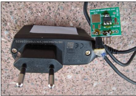
Bild 3. Zusammen mit einem Steckernetzteil hat sich Miroslav Cina (mit Hilfe der Schaltung von Bild 2) ein erstes funktionierendes Li-Ion-Ladegerät gebaut. Nachteil: Man sieht nicht, was gerade los ist.
