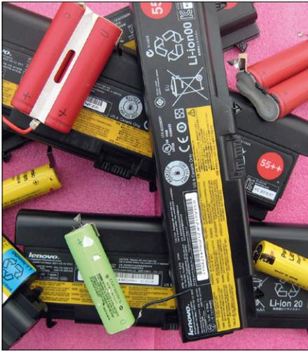
Bild 1. Konvolut ausgemusterter Laptop-Akkus mit ausgebauten Zellen. Viele davon lassen sich noch lange für andere Zwecke einsetzen.
