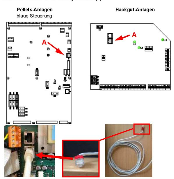
RS232 seriellen Anschluss (RX / TX / GND) am ModBus anschließen (siehe 3.2 Verdrahtung) Das Kabel darf nur bis zu einer Maximallänge von 15 Metern ausgeführt werden.
