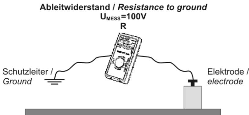
Notieren Sie immer die Temperatur- und Luftfeuchtigkeitswerte, da diese die Widerstandsmessungen beeinflussen.
