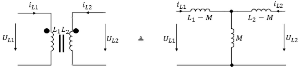
Abbildung 1: gekoppelte Spulen und Ersatzschaltbild
