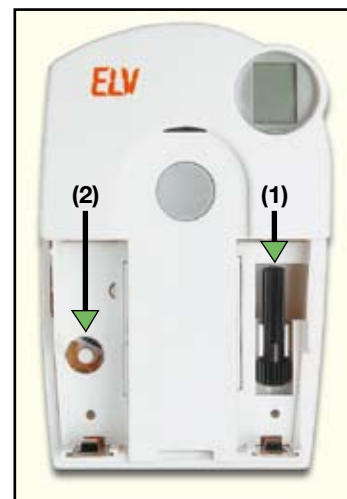
Bild 2: Verstellen des Ventils von Hand mit einem Verstellstift
