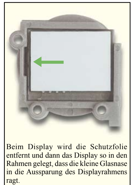
Montage des Displays im Displayrahmen
