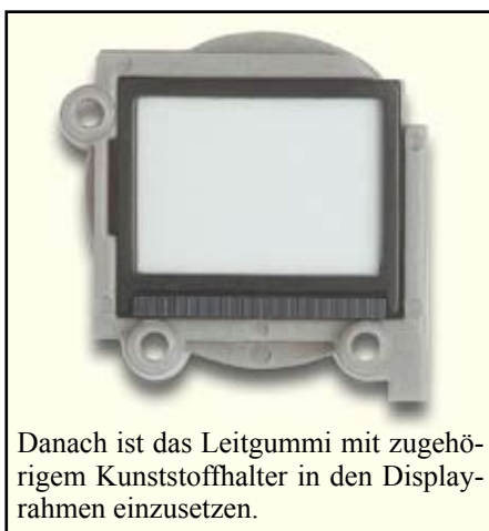
Einsetzen des Leitgummistreifens mit Halterahmen
