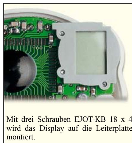
Montage der Displayeinheit auf der Leiterplatte
