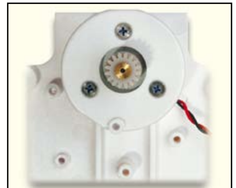
Montage des Zahnrads mit Steuerstift und Schneckenachse
