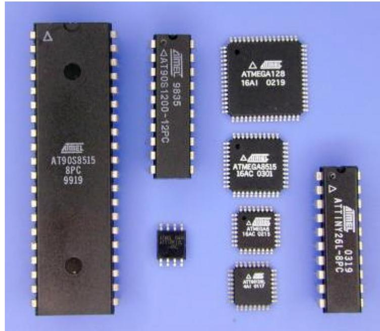
Abb. 1: Verschiedene AVR- $\mu$ C von Atmel<sup>1</sup>
