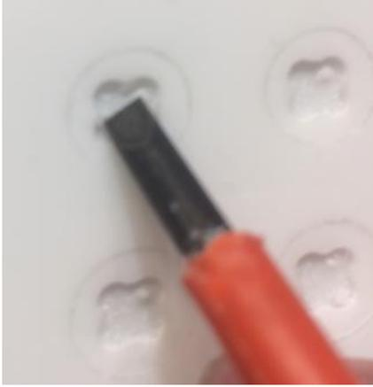
Bei der Platzierung ist unbedingt auf die Richtung zu achten. Dazu kann die Kupferplatine helfen, auf der die Richtungen und die + Zonen eingefräst sind.
