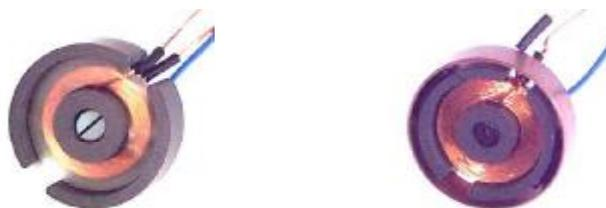
Abbildung 52: Sensor für nicht bündigen und bündigen Einbau
