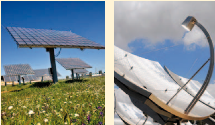
Abb. 4 In PV-Konzentratorkraftwerken wird das Sonnenlicht durch Linsen oder Spiegel auf kleine III-V Mehrfachsolarzellen fokussiert. Links eine Anlage mit CONCENTRIX™-Modulen. Rechts eine Anlage mit Parabolspiegeln. Der Receiver wird gekühlt, die anfallende Wärme genutzt.
