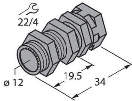
Schnellmontagehalterung mit Festanschlag; Werkstoff: Messing verchromt. Außengewinde M16 x 1. Hinweis: Der Schaltabstand der Näherungsschalter kann sich durch Verwendung von Schnellmontagehalterungen verringern.
