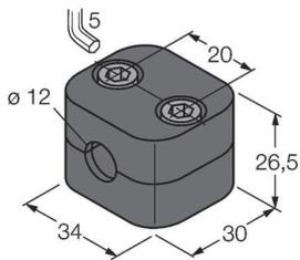
Befestigungsschelle für Glatt- und Gewinderohrgeräte; Werkstoff: Polypropylen
