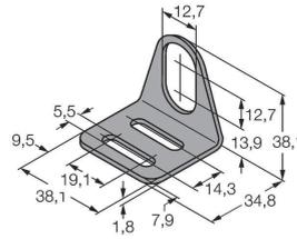
Befestigungswinkel für Gewinderohrgeräte; Werkstoff: Edelstahl A2 1.4301 (AISI 304)
