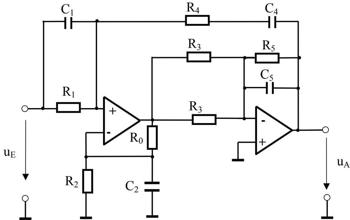
Die Operationsverstärker werden als ideal vorausgesetzt, d. h. der Ausgangswiderstand sei vernachlässigbar klein und sowohl der Eingangswiderstand als auch der Verstärkungsfaktor seien unendlich groß.
