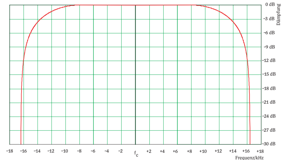
Bild 6-24 Kanalfilter bei IS-136 (NADC)
