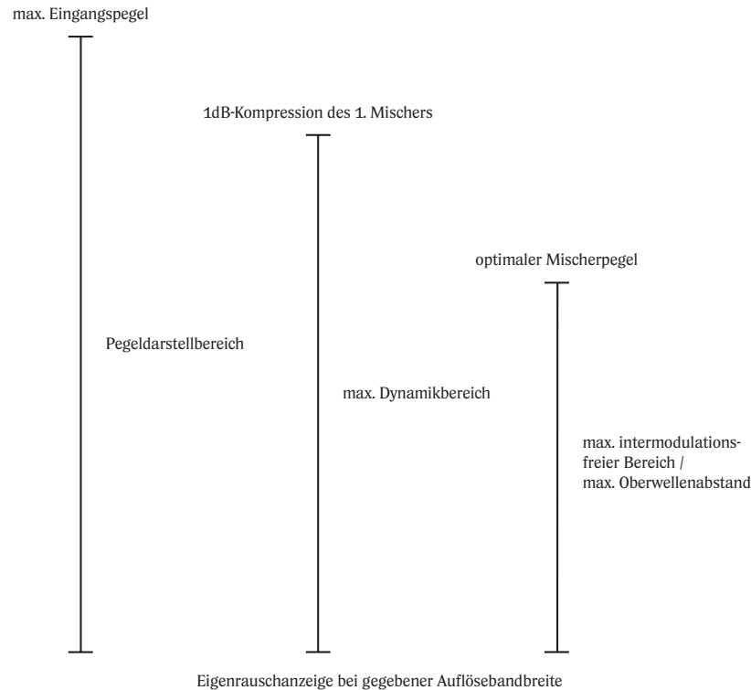
Bild 5-18 Vergleich von Pegeldarstellungsbereich, maximalem Dynamikbereich und maximalem intermodulationsfreiem Bereich
