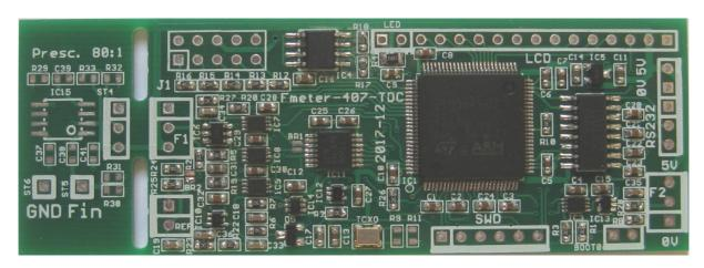
Der Vorteiler arbeitet im Frequenzbereich 10 MHz – 1,5 GHz und teilt die Eingangsfrequenz 80:1, sodaß die Ausgangsfrequenz etwa im Bereich 120 kHz – 19 MHz liegt. Passend zum verwendeten Eingang muß der Teilungsfaktor 80 eingestellt werden.
