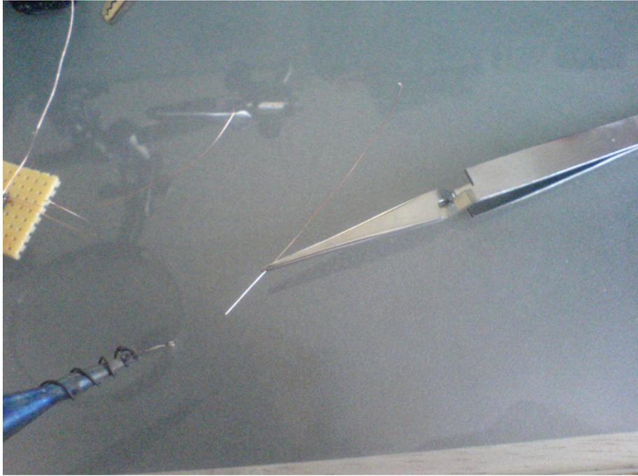
Für die Lötarbeit nimmt man am besten eine Litzenader von einem Litzenkabel und eine selbstklemmende Pinzette. Danach mit der präparierten Lötspitze und der feiner Ader unter der Lupe auf den Kontakt löten. Sind alle Kontakte dran, die Länge zuschneiden und in die dazugehörigen Rasterlöcher stecken. Anschliessend mit einer Steckleiste versehen und Löten. Die Kontakte sollte vorher noch mit einem Mikroskop oder einer starken Lupe kontrolliert werden.
