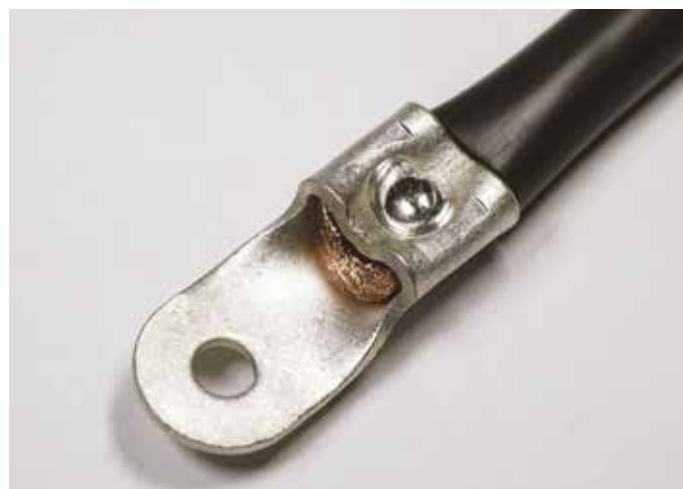
Bild 13: Quetschkabelschuh mit Dornpresseinsatz Q22 verpresst
