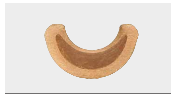
Bild 11: Schliffbild Dornpressung Klasse 6 Leiter im F-Kabelschuh
