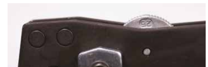
Bild 6: K05 Detail Stellrad (hier 25 mm² gewählt)
