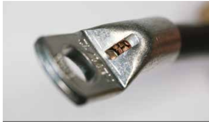
Bild 5: Kabelschuh mit Sichtloch zur Einschub-Kontrolle
