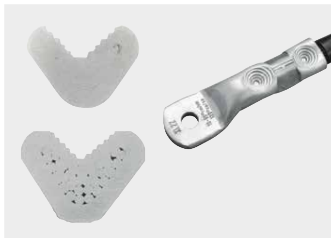
Bild 7: Schliffbild Aluminium Klasse 1, 2 und verpresster Kabelschuh Al-Serie (Dornpressung)
