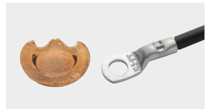
Bild 17: Kerbpressung (Doppeldorn) Schliffbild und verpresster Kabelschuh
