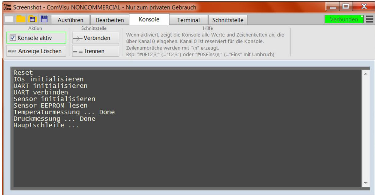
Zur Fehlersuche können im Terminal die eingehenden Zeichen angezeigt werden, es werden die daraus gefilterten Befehle aufgelistet und markiert, ob sie verarbeitet wurden, d.h. ob ein Instrument vom entsprechenden Kanal abhängt.
