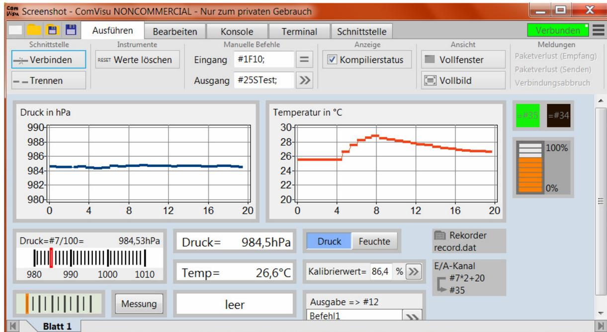
In der Bearbeitenoberfläche werden Instrumente platziert und konfiguriert. Das blau hinterlegte Feld Eingang (bzw. Ausgang) im Eigenschafteneditor legt den Kanal fest, das Aussehen der Anzeigen kann weitgehend dem eigenen Bedarf angepasst werden.
