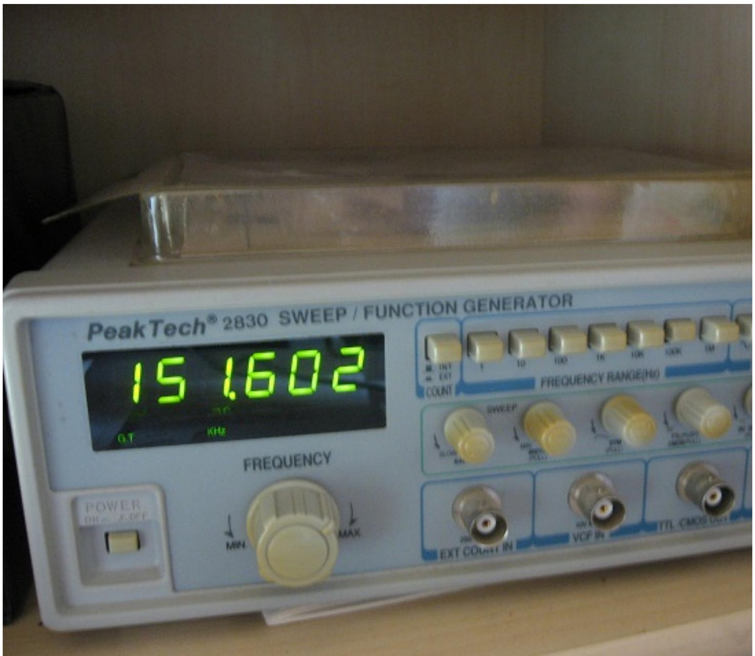
Als Signalgenerator (Sinus-, Rechteck- und Dreieckssignale), Impulsgenerator und Wobbelsender nutzbar. Beim Wobbeln variiert die Frequenz zyklisch zwischen 2 Grenzfrequenzen. Es kann das Frequenzverhalten von aktiven und passiven Bauelementen bis 2 MHz überprüft werden.
