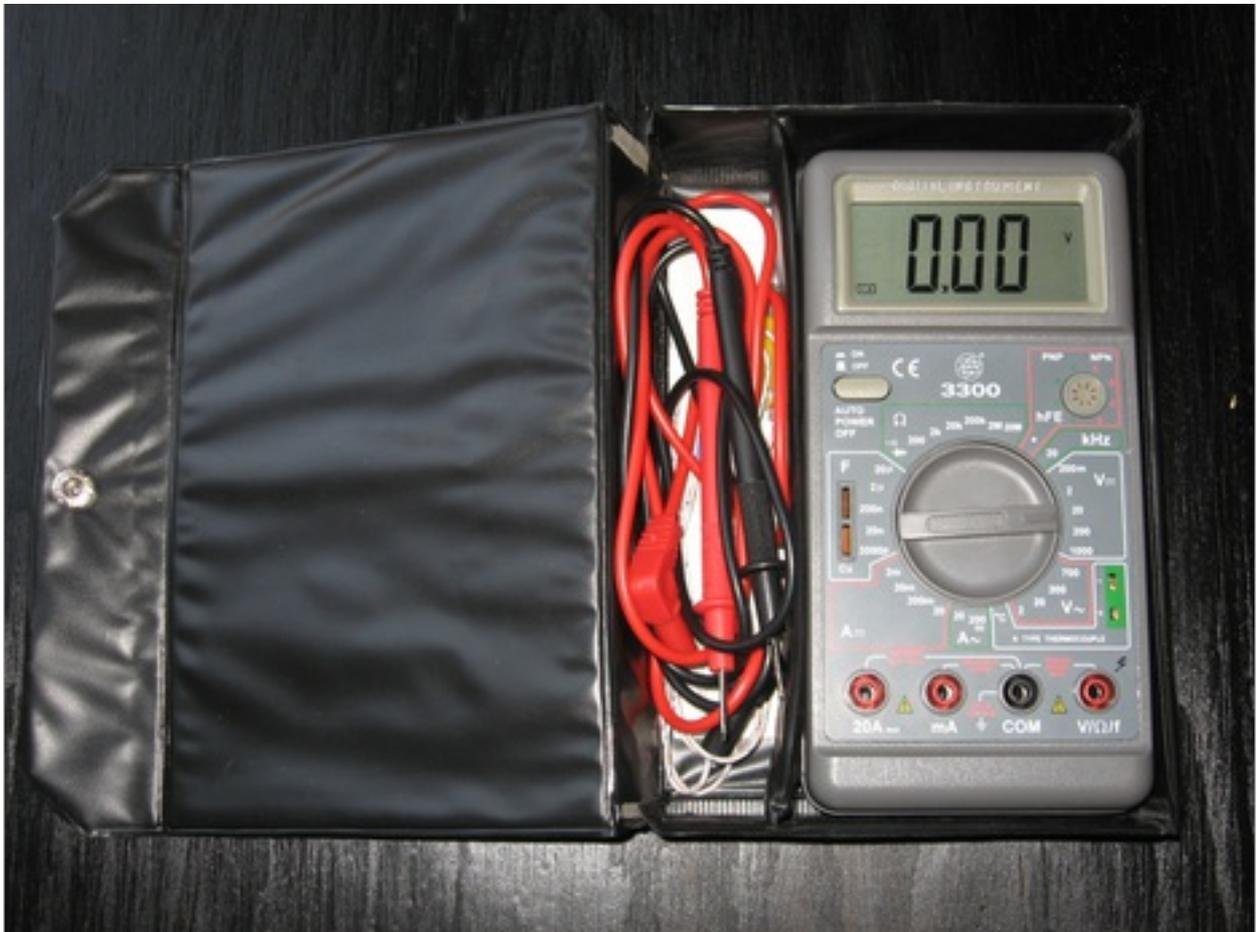
Messung von Gleichströmen von 2 mA bis 20 A und Wechselströmen von 200 mA bis 20 A.
