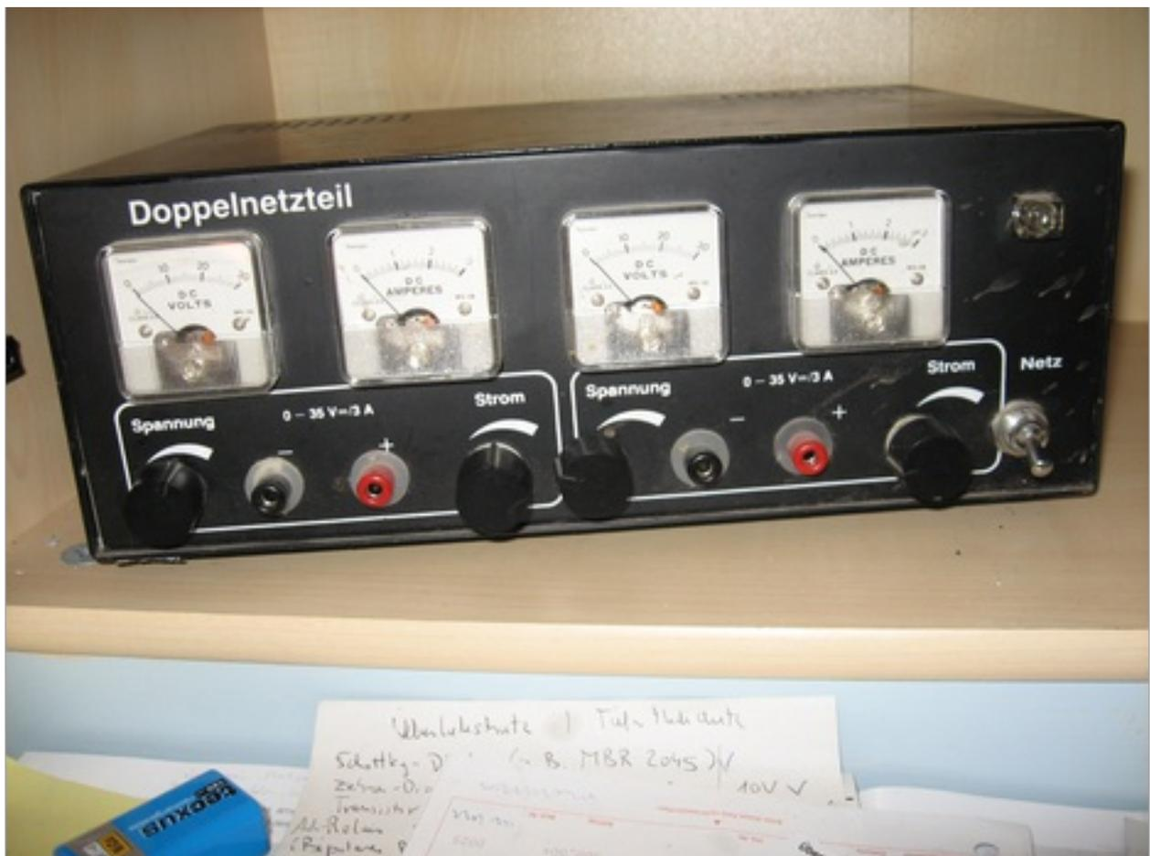
Spannungen erzeugen, die man beispielsweise bei Verstärkern, Operationsverstärkern, Endstufen, Microprozessoren, usw. braucht.
