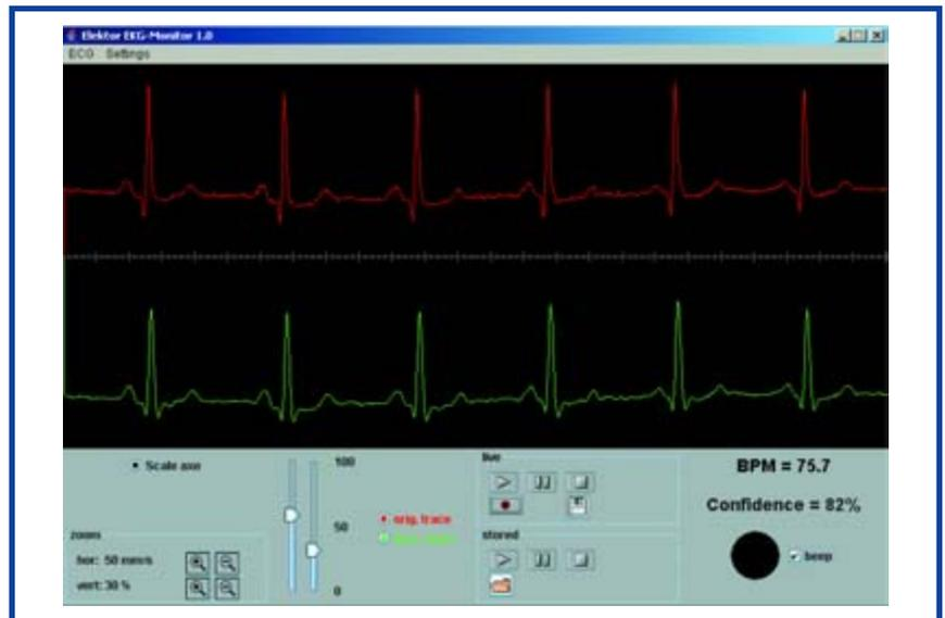
**Bild 7.** Im Haupt-Programmfenster ist oben das Original-Signal und unten das verarbeitete Signal zu sehen.
