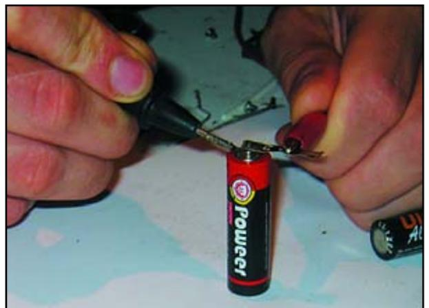
Verbinden Sie das Bändchen mit einer der Schweißelektroden. Mit der anderen Schweißelektrode berühren Sie den Akkukontakt. Fertig machen zum Funkenflug!
