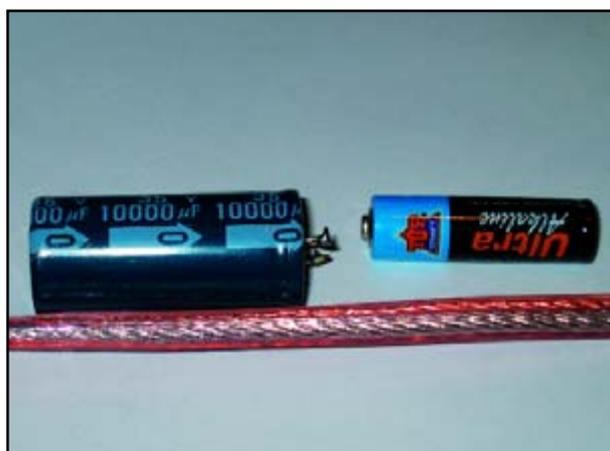
Die Kondensatoren sind hier die wichtigsten Bauteile. Von diesen 10.000-µF-„Öschis“ verbinden wir gleich acht Stück mit dickem Lautsprecherkabel (die Batterie dient zum Größenvergleich).
