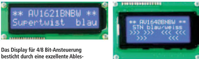
Das Display für 4/8 Bit-Ansteuerung besticht durch eine exzellente Ablesbarkeit. Der Standard-Zeichensatz ist bereits implementiert. Als Hintergrundbeleuchtung dient weißes Halbleiterlicht.
