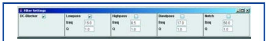
**Bild 8.** Im Fenster „Filter Settings“ lassen sich die in der Software realisierten Biquad-Infinite-Impulse-Response-Filter konfigurieren.
