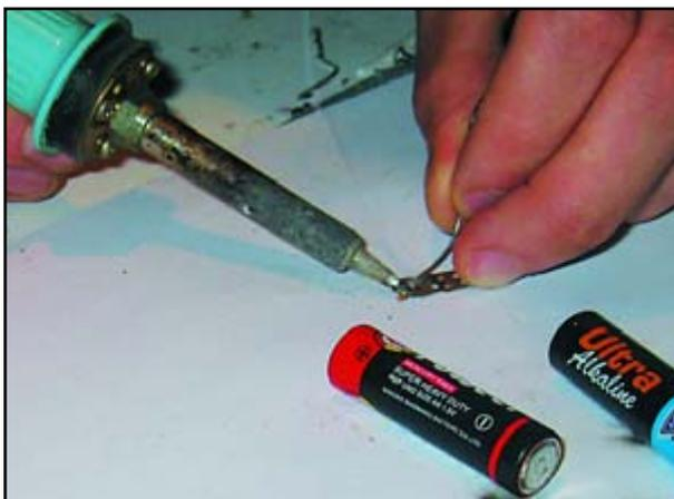
Das Metallstück sollte man an der Stelle, an der es festgeschweißt wird, gut verzinnen. Zinn schmilzt nämlich besser als das Blech oder der Batteriekontakt selbst.
