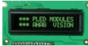
Dieses Modul besticht durch eine anspruchsvolle Farbgebung. Die selbstleuchtenden, gelben Zeichen auf schwarzem Grund ermöglichen eine brillante Ablesbarkeit. Der Standard-LCM-Zeichensatz ist "On Board". Ansteuerung über 4/8 Bit Datenbus (parallel).
