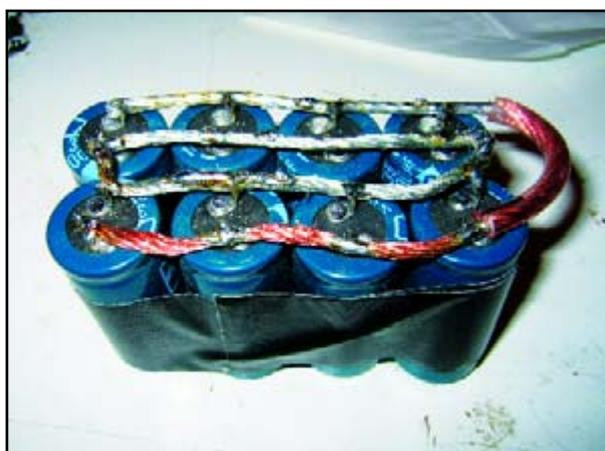
Voilà: Das Lautsprecherkabel wurde an den Lötstellen abisoliert und gut verzinkt.
