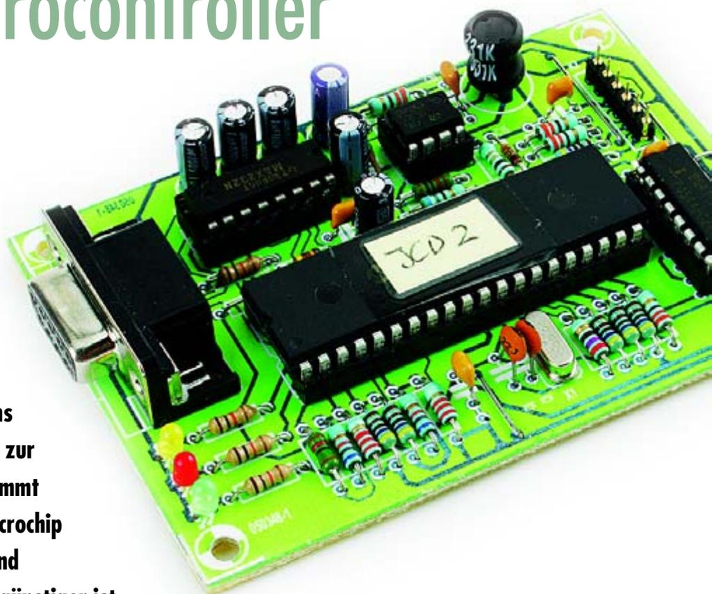
Schon mit geringem Aufwand ist es möglich, interessante Applikationen mit den 8-bit-PICs 16F und 18F aufzubauen. Die Entwicklungsumgebung einschließlich Assembler und Simulator ist beim Hersteller [1] frei erhältlich. Für die Programmierung in Hochsprachen bieten verschiedene Hersteller C-Compiler an.
