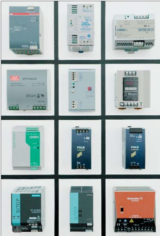
Bild 1. Die Geräte im Test von links oben nach rechts unten (a = aktive PFC, p = passive PFC): ABB CP-C 24/10.0 (a); Idec P55R-SG24 (a); Lambda DLP240-24-1/E (a); Mean Well DRP-240-24 (a); MTM HSA 240S24 (p); Omron S8VS-24024AP (a); Phoenix Contact QUINT-PS-100-240AC/24DC/10 (a); Puls CS10.241 (p); Puls QS10.241 (a); Siemens SITOP modular 10 A (p); Siemens SITOP smart 10 A (p); Weidmüller CP SNT 250W 24V 10A (p). Die Frontansicht der getesteten Schaltnetzteile vermittelt einen Größeneindruck der Geräte. Die zwei kleinsten Stromversorgungen (Puls) benötigen zusammen ungefähr so viel Platz wie das größte Gerät (Weidmüller). Detaillierte Angaben zur Leistungsdichte enthält Tabelle 1. (Bild: M. Weiland)
