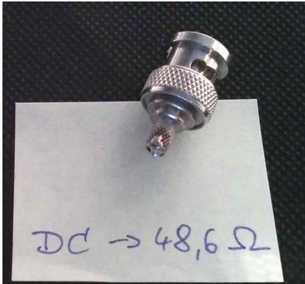
Bei diesem Prüfling handelt es sich um einen 50 Ohm Coax-Stecker zum Crimpen mit eingelötetem Drahtwiderstand, bei DC Messung knapp unter 49 Ohm.
