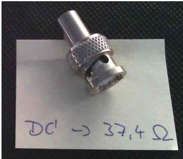
Bei dem hier verwendeten Bauteil handelt es sich um einen Leitungsabschluss für Coax-Ethernet, der gerne auch auf Meßgeräte im Labor gesteckt wird.
