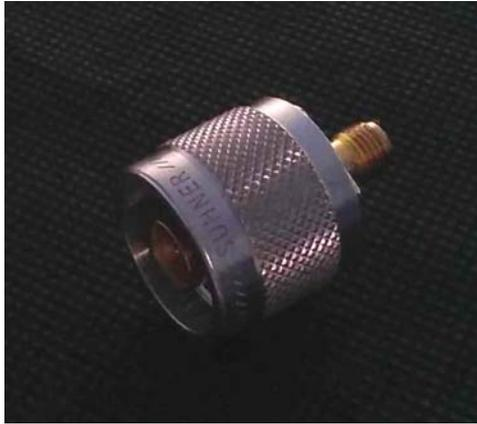
Nun wird der Übergang von N auf APC3.5mm entfernt und ein 10dB Dämpfungsglied an der Stelle angeschraubt, wo sich zuvor der N-Übergang befand. Die Meßkurve liefert die 20dB Anpassung und zeigt, dass der Ursprung des Smith-Diagramms schön in der Mitte der Kurve liegt, auch wenn nun die Referenzebene zum VNA gerückt ist,
