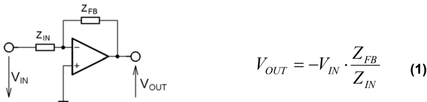
Bild 4: Invertierender Verstärker
