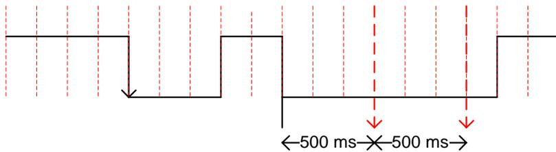
Abbildung 34: Taster-Signal Abtastung
