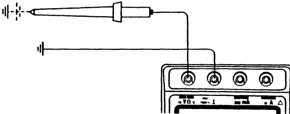
Meßbereich auf 20 V, 200 V oder 1000 V Gleichspannung stellen.
