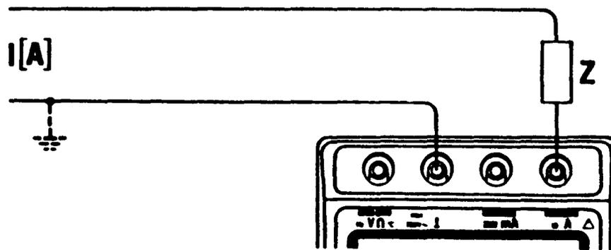
Mit Zentralschalter die gewünschte Funktion einstellen. Meßgröße an Buchsen "10 A" und "10 A" legen. Dieser Strombereich ist mit einer Sicherung (12 A) abgesichert. Diese ist durch Öffnen des Gerätes (Rückwand) austauschbar. Eine defekte Sicherung wird durch das Symbol "☒" signalisiert.
