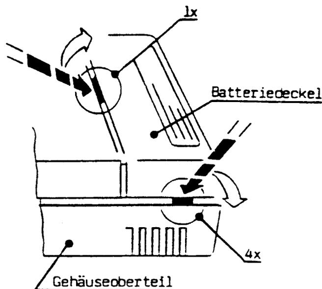
Die beiden Hochstromsicherungen für die Bereiche bis 2 A und den 10 A-Bereich befinden sich im Inneren des Meßgerätes (Lage siehe Punkt 4. "Anordnung der Bedienungselemente"). Das Öffnen erfolgt durch schräges Einführen des Schraubendrehers in die seitlichen Nuten (4 Stk.) und Hochziehen des Schraubendrehers. Es kann nun der Tausch der Hochstromsicherungen erfolgen. Dann wieder Gehäusedeckel aufsetzen und einschnappen.
