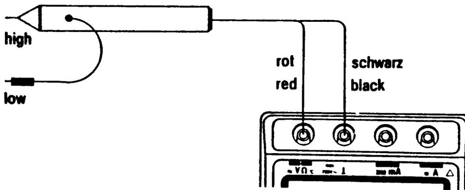
Meßbereich auf 2 V, 20 V oder 200 V Gleichspannung stellen.
