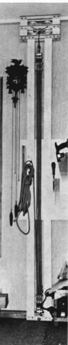
Abb. 7-9. Links die ursprüngliche „Antriebsform“: ein von Hand bedienter Flaschenzug, daneben (außen rechts mit Plexiglas-Schutzverkleidung) der motorische Antrieb mit Steuerkasten zum Heben und Senken der Anlage. Motor: 220 V ~, 185 W, 1410 U/min. Schnecken-Übersetzung 1:50, Spindelbewegung: 28,2 U/min; Hubzeit (für ca. 1 m Höhe): 5 min.
