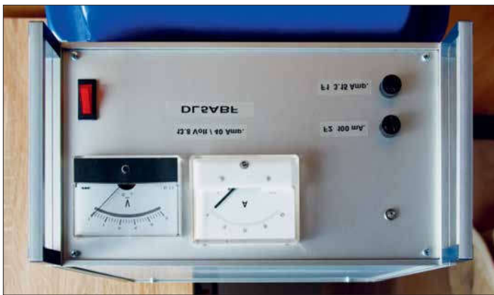
Bild 1: Frontansicht des 12-V-Stromversorgungsgeräts, das bis zu 40 A liefern kann. Im Metallgehäuse ist ein leistungsfähiges, entstörtes Schaltnetzteilmodul untergebracht.
