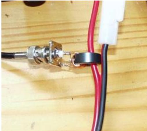
Messung Gegentaktstörungen: Der Messkopf wird nur über die Plusleitung geschoben, da die Sicherungen in der Versorgungsleitungen sitzen, braucht dazu kein Stecker abgebaut werden. Lediglich die Sicherung herausnehmen, Messkopf aufbringen, Sicherung wieder einsetzen.
