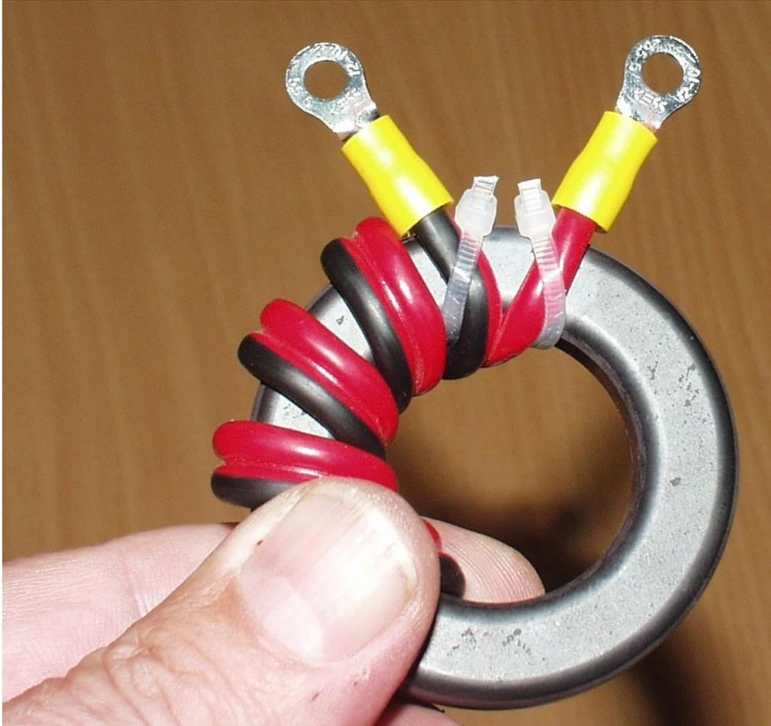
Das abgeschnittene Stück Versorgungsleitung wird um einen 60 mm Ferritkern gewickelt nach dem Wickelschema W1JR. Soviel Windungen, wie auf den Kern passen, mindestens aber 10. Vergleichbar mit einem Balun vom Typ Sperrglied. Er soll die 13,8 V Versorgungsspannung von Störsignalen reinigen, die beide Adern in gleiche Richtung durchfließen. (Gleichtaktstörungen)
