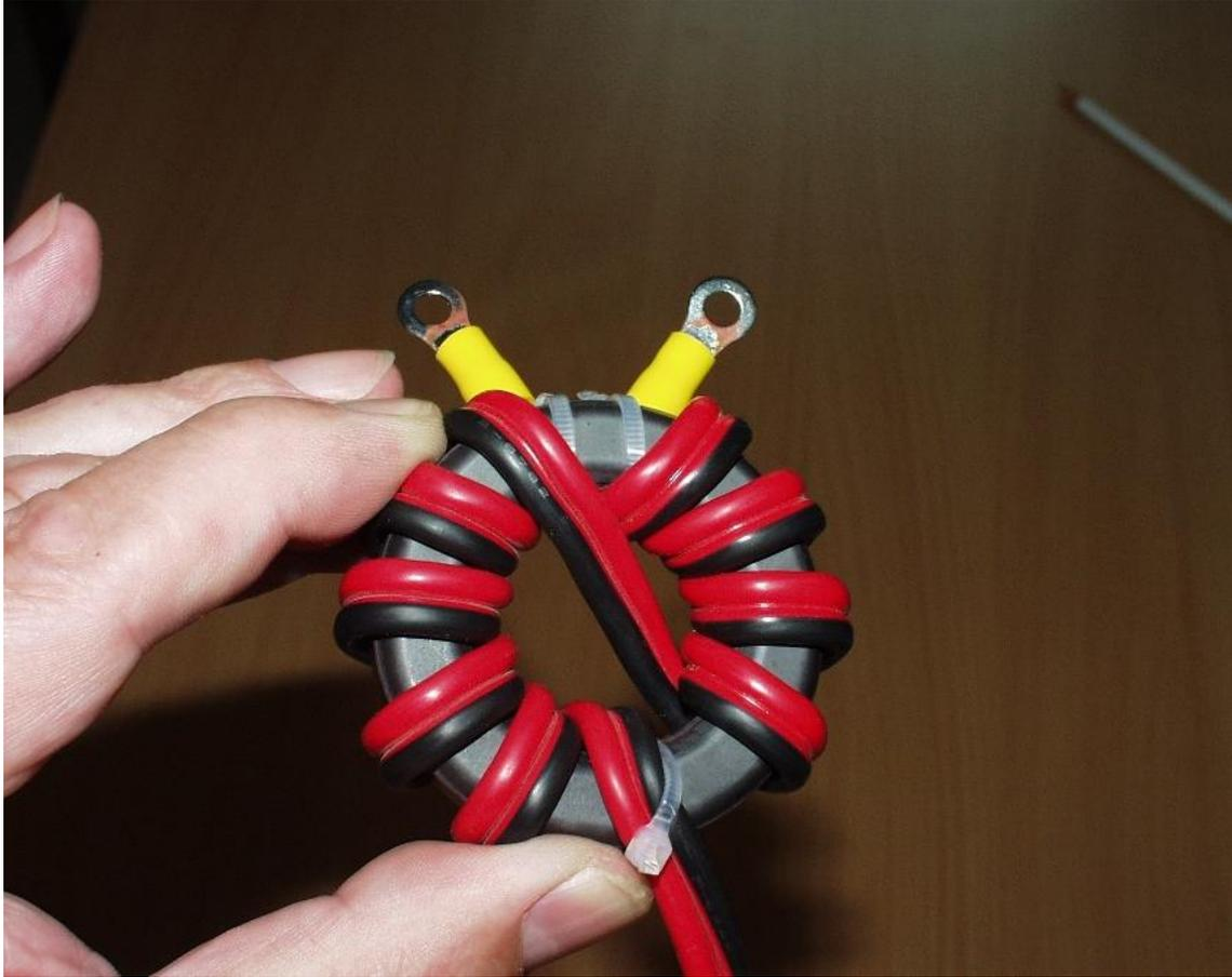
Die Versorgungsleitung mit einem Kern zu einer Mantelwellensperre aufwickeln führt nicht zum Erfolg! Die Störung ist eine leitungsgeführte Welle, die Ströme liegen im Gegentakt. Daher kommt es im Ferrit zu keinem Fluss, die Induktivität ist Null. Die Störung auf der Leitung wird nicht beeinflusst.
