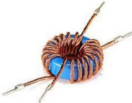
Um Gegentaktstörungen zu unterdrücken kann man entweder den Wickelsinn einer der beiden Wickel der stromkompensierten Drossel umdrehen (oben)
