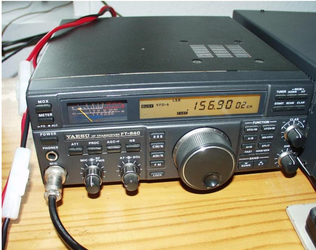
Der RX zeigt bei der Prüfung auf Gleichtaktstörungen eine Pfeifstelle bei 157 kHz, die Signalstärke ist kleiner als S1
