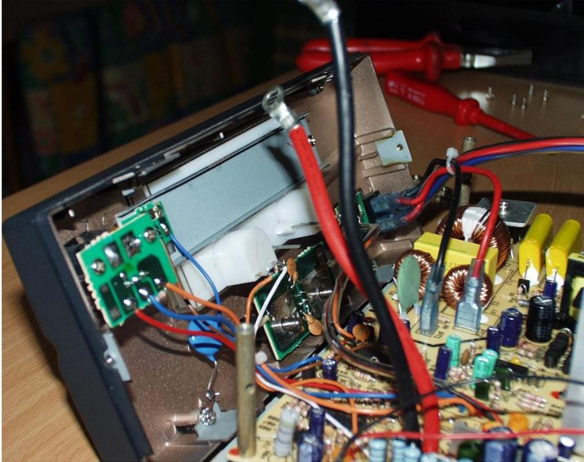
Die beiden dicken Drähte werden von den Buchsen an der Frontseite gelöst.
