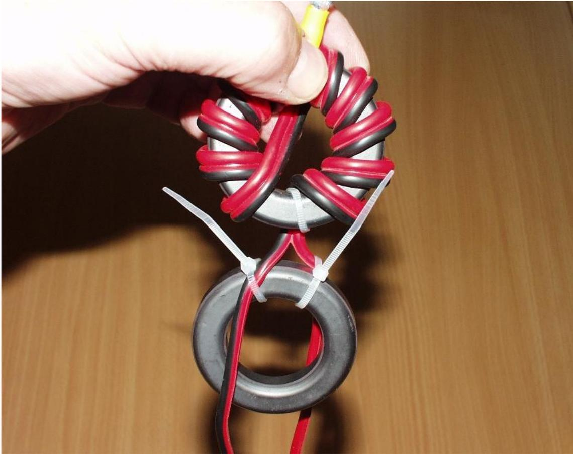
Mit Kabelbindern werden die Litzen am Kern befestigt, eine oberhalb und eine unterhalb des Kerns. Diese Bewicklung hilft gegen Störungen, die gegenphasig beide Litzen zu ihrer Ausbreitung nutzen, das heißt, Gegentaktstörungen werden durch die magnetische Induktion im Ferrit unterdrückt.
