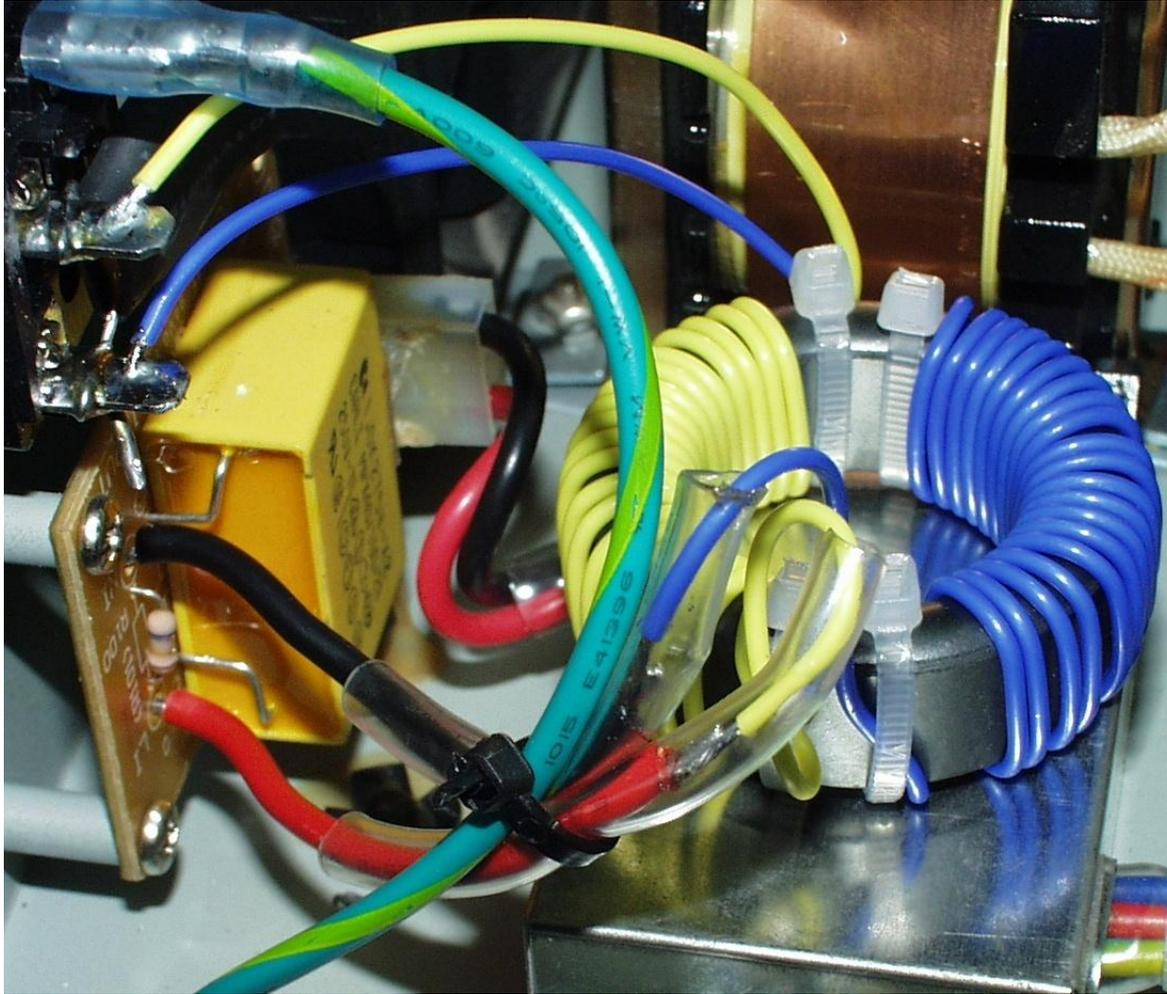
Der Isolierschlauch wird über die Lötstelle gezogen und alles am Erdanschluss (das ist der gelb-grüne Schutzleiter) mit einem Kabelbinder fixiert.
