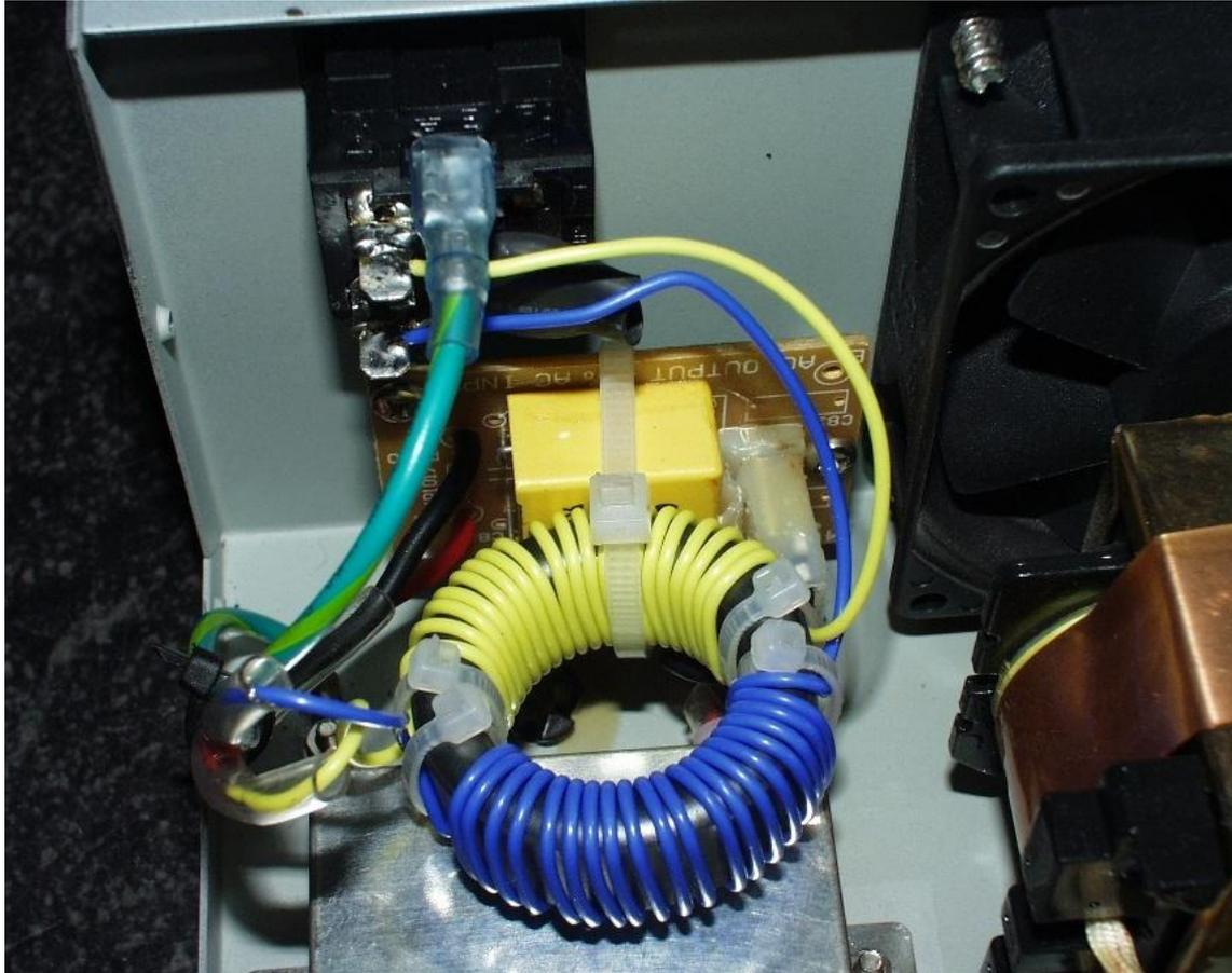
Zum Schluss wird die Drossel mit einem weiteren Kabelbinder an der Platine mit dem gelben Kondensator festgezurr.
