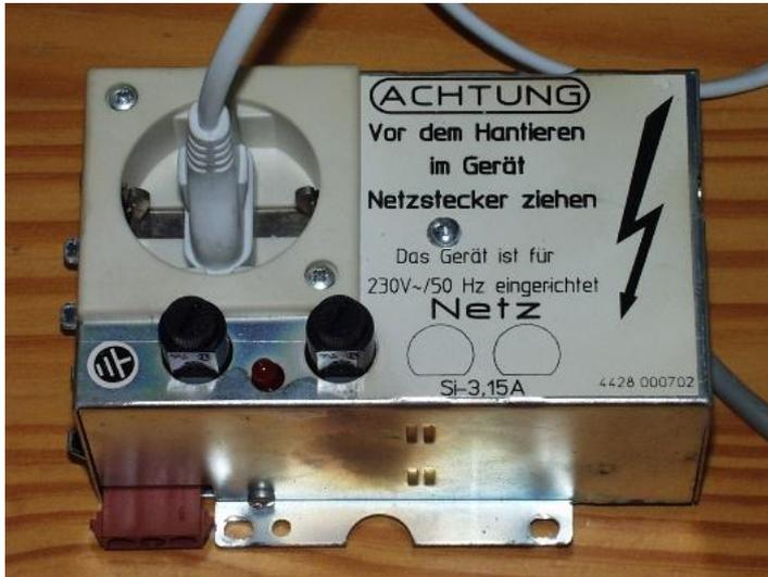
Bevor die Störungen aus dem Netz nicht beseitigt sind, ist es zwecklos, sich mit dem Störspektrum des Schaltnetzteiles zu beschäftigen. Da kommt mir ein Netzfilter aus einem ausgeschlachteten Spielautomaten gerade recht.
