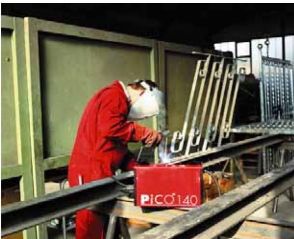
**Bild 22** Anwendung des E-Hand-Schweißens beim Geländerbau
