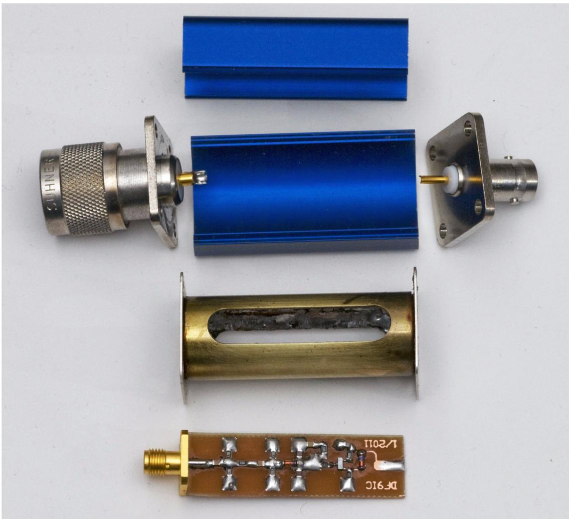
**Bild 16** Eigenbau-Quelle mit Zenerdiode; Leiterplatte und möglicher Gehäuseeinbau
