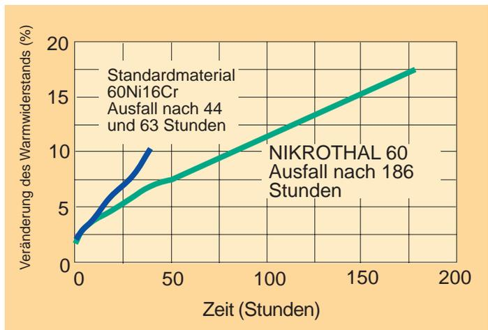
Bild 6. Lebensdauer und Warmwiderstandsveränderung für 60Ni16Cr-Legierungen bei einer konstanten Leistung von 200 W. Zyklischer Betrieb von 2 Minuten AN und 2 Minuten AUS.
