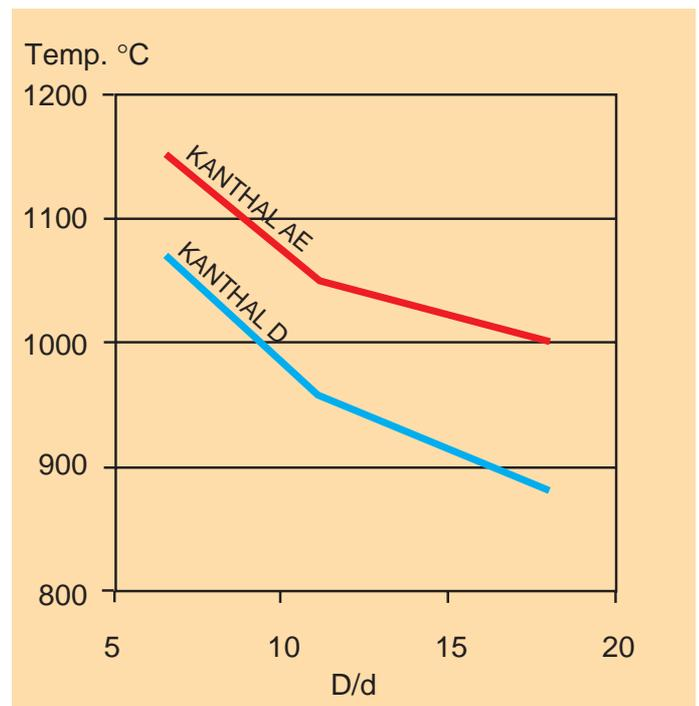
Bild 10. Zulässige D/d-Verhältnisse als Funktion der Heizleitertemperatur
