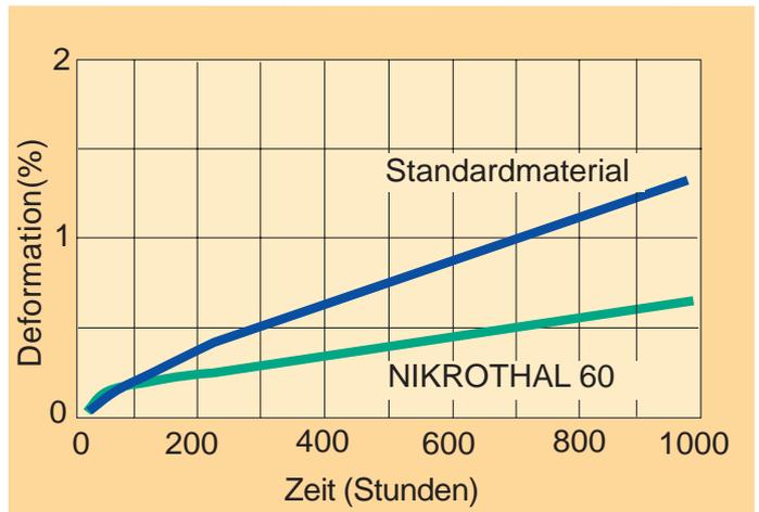
Bild 4. Zeitbezogene Verlängerung von NIKROTHAL 60 verglichen mit Standardmaterial. Getestet wurde ein Draht, Ø 4 mm, mit einer Belastung von 1,5 MPa
