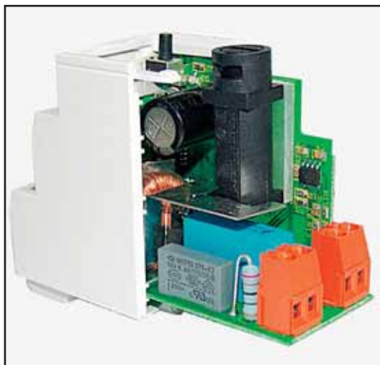
Bild 5: Das Einsetzen in das Hutschienengehäuse – auf saubere Führung der Platine in den Gehäusenuten achten!
