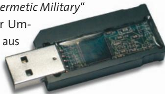
Mit der vollständigen Kapselung der Elektronik und dem vollständigen Verbund mit dem Gehäuse schützt der altec „Full Metal Stick Hermetic Military“ Ihre Daten zuverlässig vor Flüssigkeiten, Staub, Dreck, Schock und Vibration.
