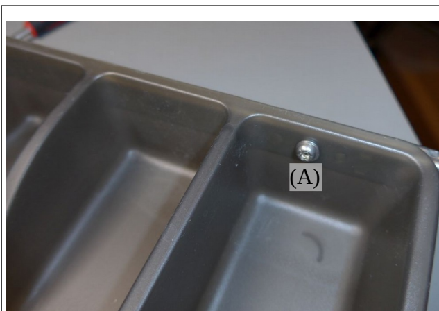
Abbildung 2: Schraube (A) M4x6 mit zwei Unterlegscheiben von Innen einsetzen.
