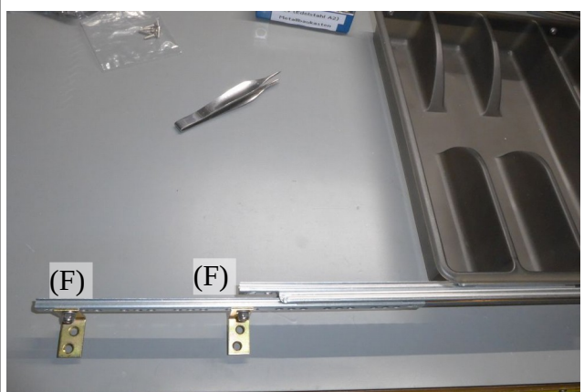
Abbildung 15: Winkel aufsetzen und mit Unterlegscheiben und Stoppmuttern M4 vormontieren.
