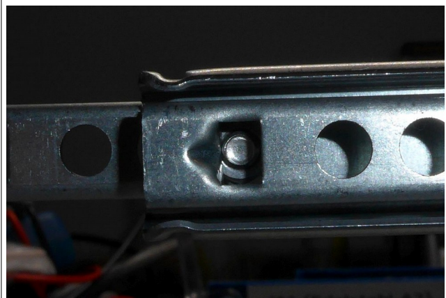
Abbildung 11: Schiene (II) aufsetzen. Unterlegscheibe und Flachmutter M4 einsetzen. Schiene (II) so einschieben, dass die Stopper-Zunge die Mutter blockiert. Schraube (D) anziehen.
