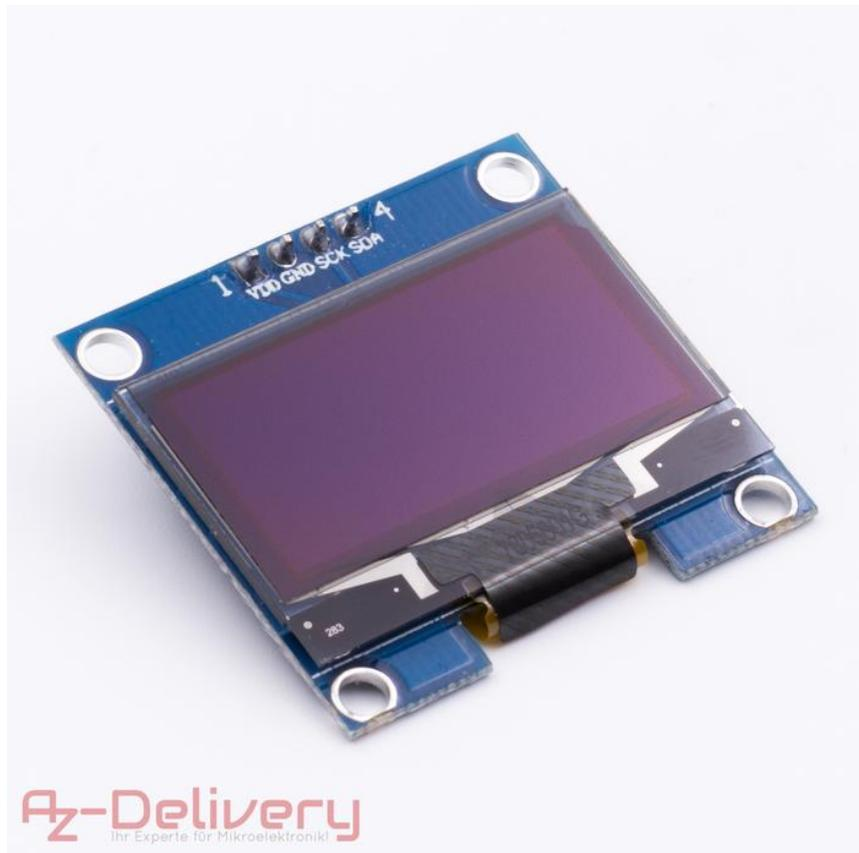
Das Display mit 1,3" hat eine Auflösung von 128 x 64 Pixel und einen starken Kontrast. Zur Ansteuerung steht eine i<sup>2</sup>c Schnittstelle mit dem Standard-Controller SH1106 zur Verfügung.
