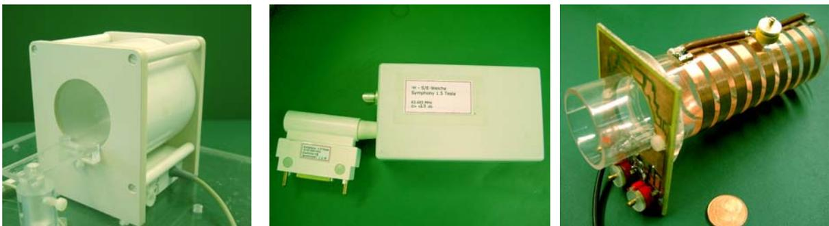
**Abb. 3.13:** Links: Bestehender Tierresonator des DKFZ, der aus einer Solenoid-Sende-Empfangsspule besteht. Mitte: Sende-Empfangsweiche des Tierresonators zur Trennung des Sendepfades vom Empfangspfad. Rechts: Einzelspule, die als Sende-Empfangsspule betrieben wurde. Auf der Platine befinden sich die Trimmkondensatoren zur Impedanzanpassung.
