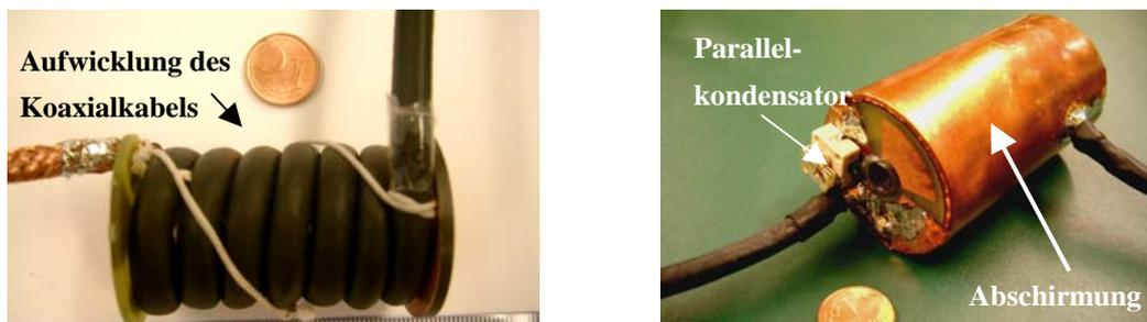
**Abb. 3.12:** Aufwicklung des Koaxialkabel, das den Vorverstärker mit dem MR-Tomographen verbindet (links) und mit einem Parallelkondensator auf Resonanz gebracht, um Ströme auf dem Außenleiter zu dämpfen (rechts).
